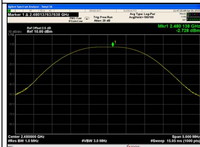
AV Output power - High CH 2480
