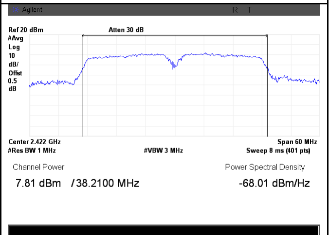
802.11n40 - AV Output power - Low CH 2422
