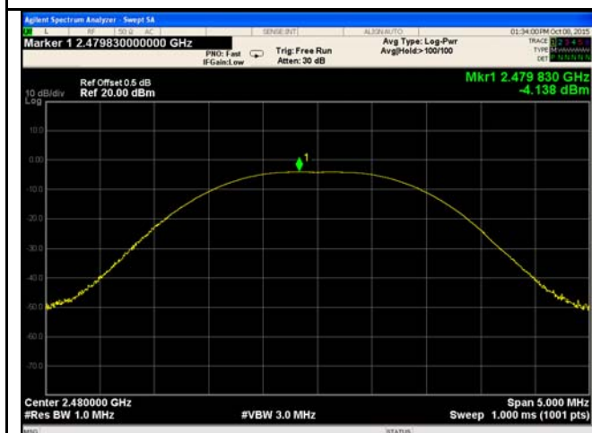
AV Output power - High CH 2480
