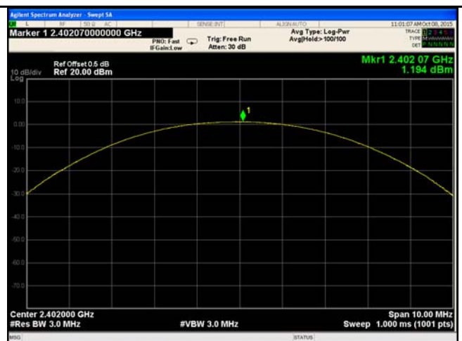
\pi/4 DQPSK Output power - Low CH 2402
