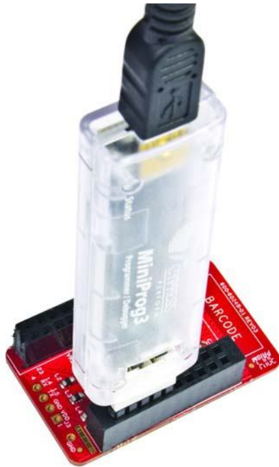
Figure A-2. Programming a BLE Module via MiniProg3
