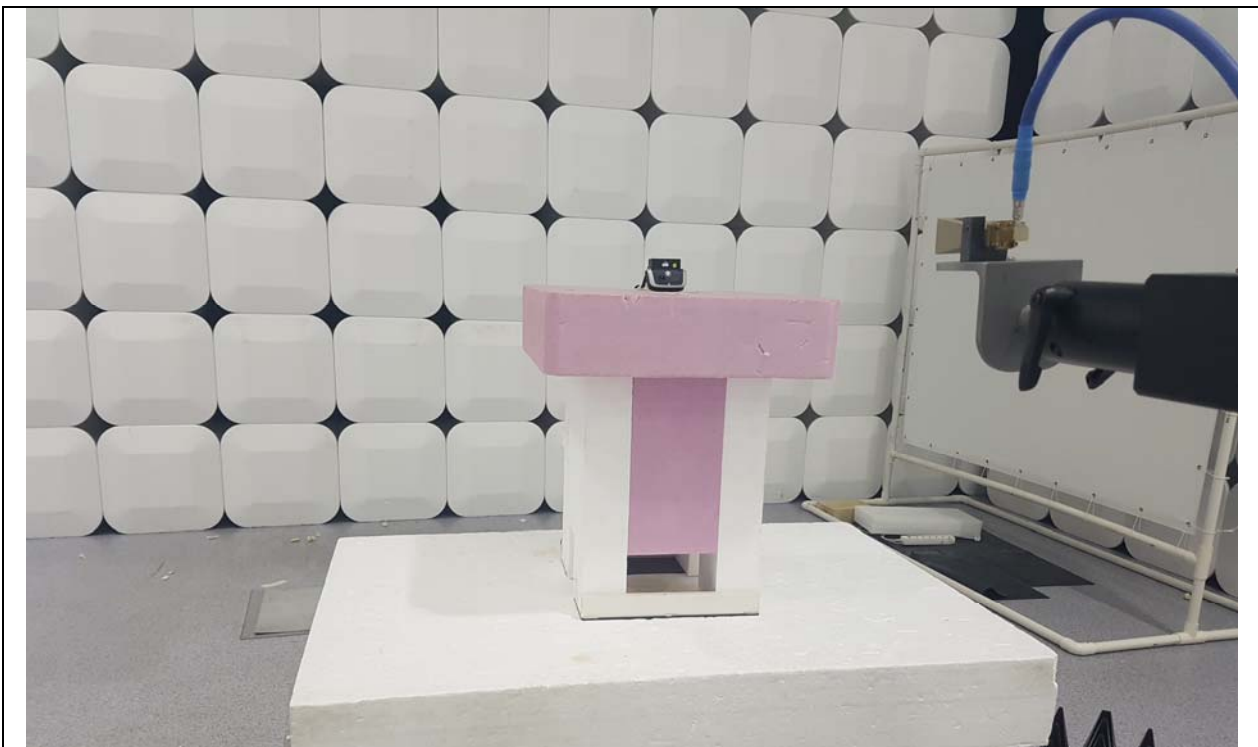
Test distance : 1 m, height of table : 1.5 m
