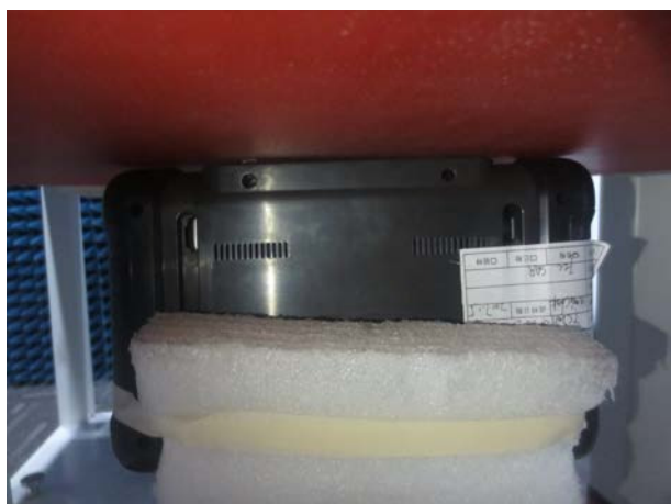
Edge 1 with Phantom 0 mm Gap
