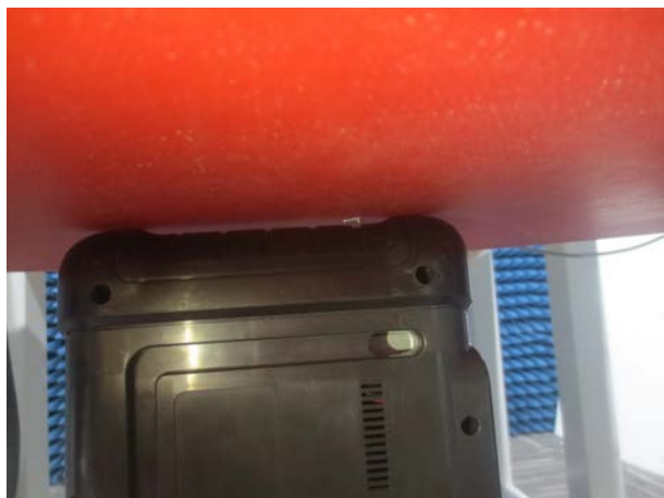
Edge 4 with Phantom 0 mm Gap
