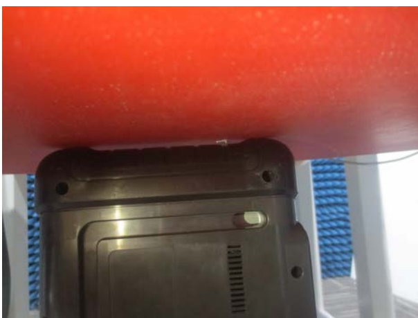
Edge 2 with Phantom 0 mm Gap
