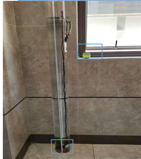
7. 浸水试验开始(30 分钟倒计时)
