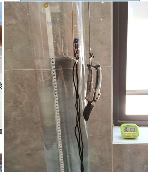
7. 浸水试验开始(30 分钟倒计时)
