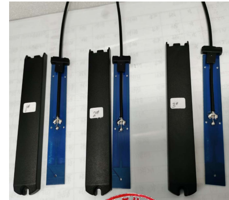
4.内部结构检查，未发现有水珠进入
