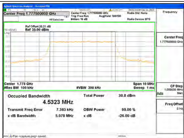
B66 / 5MHz / QPSK/ High CH
