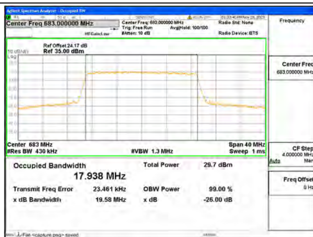
B71 / 20MHz / QPSK/ Mid CH
