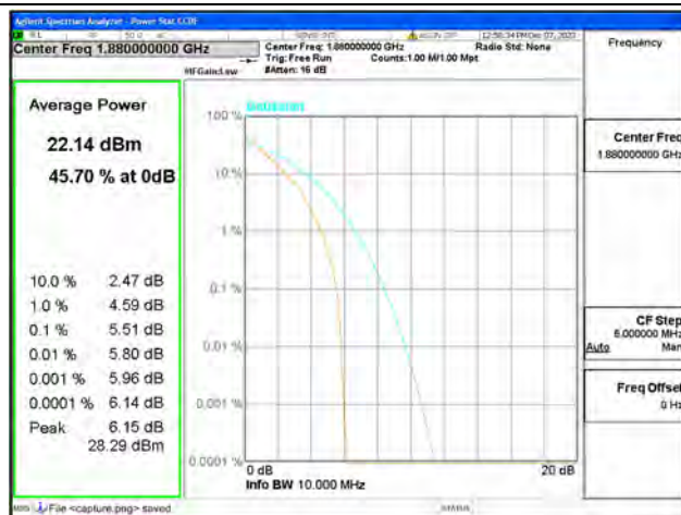
B2 / 10MHz / Mid CH / QPSK
