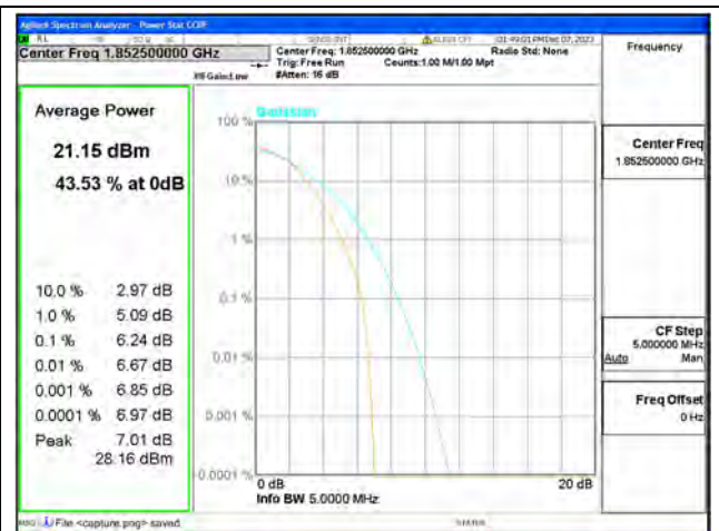
B25 / 5MHz / Low CH / 16QAM
