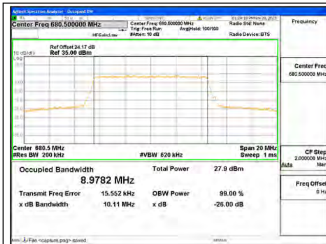
B71 / 10MHz / 64QAM/ Mid CH
