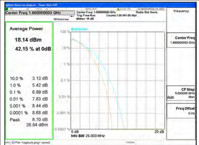
B25 / 20MHz / Low CH / 256QAM
