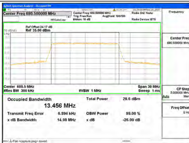
B71 / 15MHz / QPSK/ Mid CH
