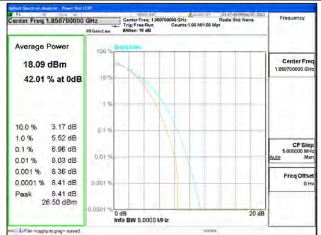
B25 / 1.4MHz / Low CH / 256QAM
