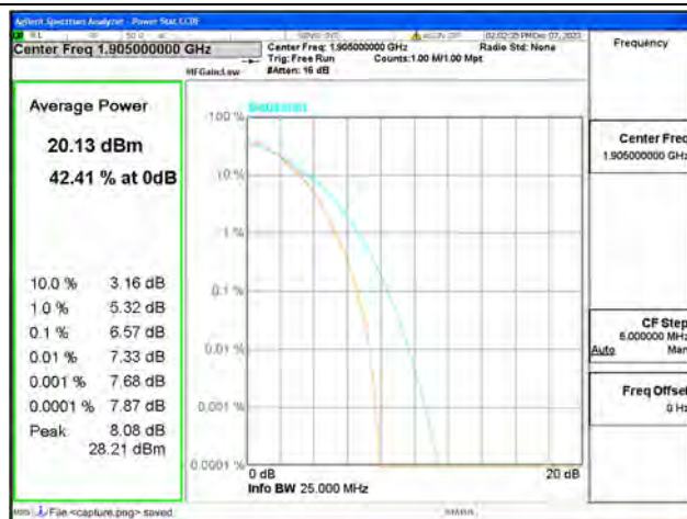
B25 / 20MHz / High CH / 64QAM
