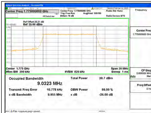
B66 / 10MHz / QPSK/ High CH
