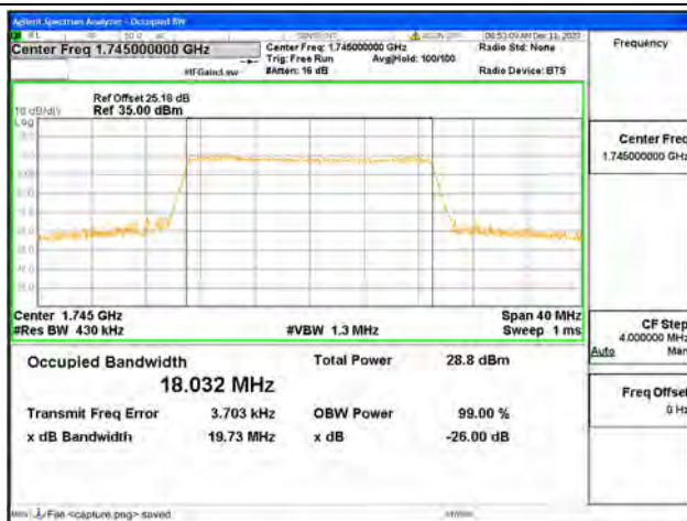
B66 / 20MHz / 64QAM/ Mid CH
