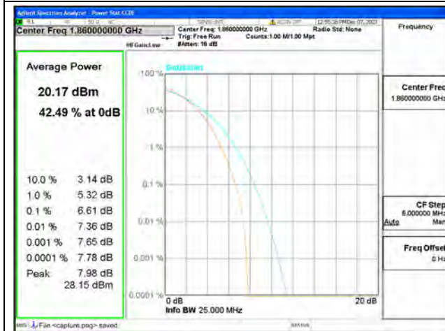
B2 / 20MHz / Low CH / 64QAM
