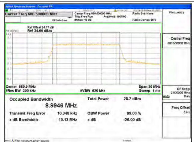
B71 / 10MHz / 16QAM/ Mid CH
