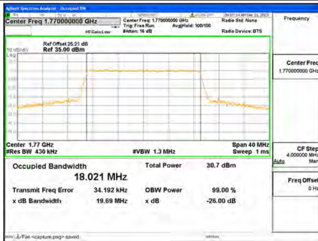
B66 / 20MHz / QPSK/ High CH
