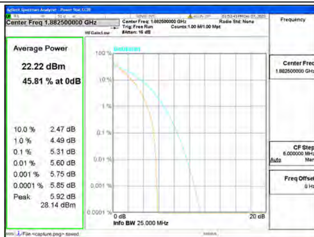
B25 / 20MHz / Mid CH / QPSK
