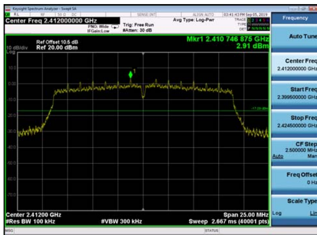
,Plot 1,Reference Level-802.11n(HT20) ,2462MHz
