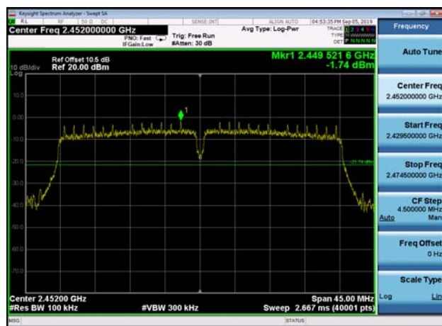
,Plot 1,Reference Level-802.11n(HT40) ,2452MHz
