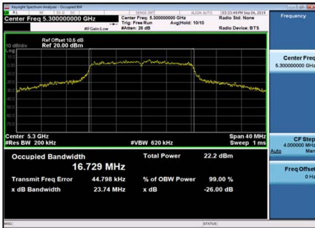
U-NII-2c 26dB Bandwidth-802.11n(20MHz )5500MHz
