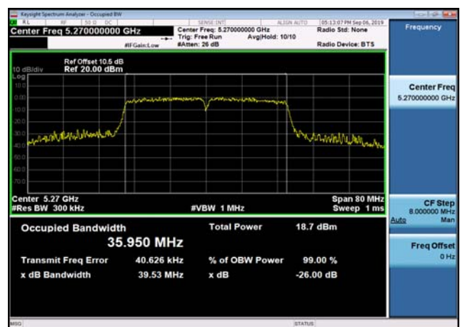
U-NII-2a 26dB Bandwidth-802.11n(40MHz) ,5270MHz
