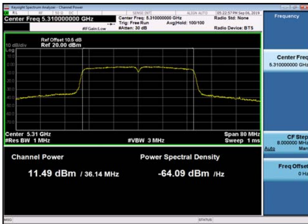
U-NII-2a Output Power-802.11a(20MHz) ,5300MHz
