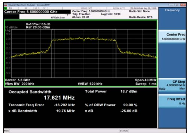
U-NII-2c 26dB Bandwidth-802.11n(20MHz )5600MHz
