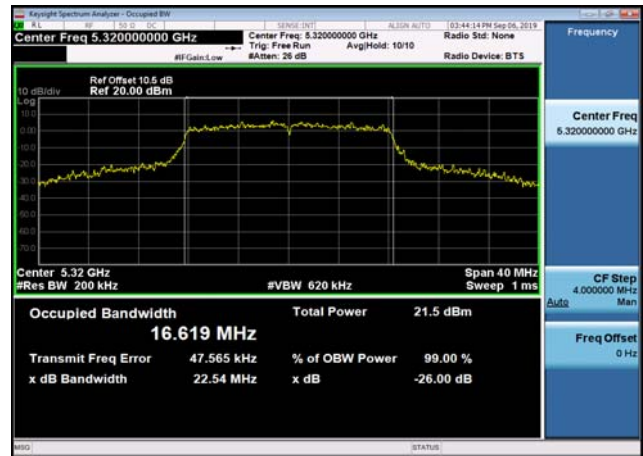
U-NII-2c 26dB Bandwidth-802.11n(20MHz )5600MHz
