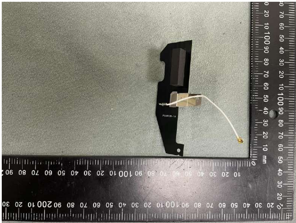
LTE Antenna: ANT0
