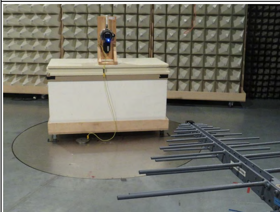
EUT 1 test setup 200 - 1000MHz horizontal
