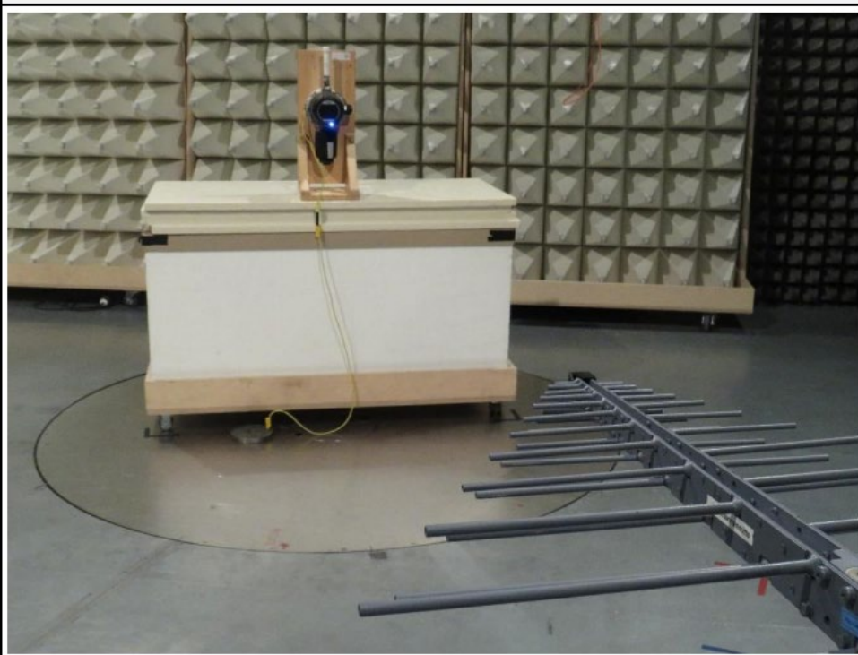
EUT 1 test setup 200 - 1000MHz horizontal
