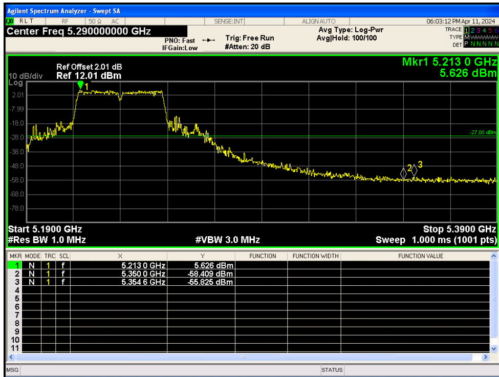
Band Edge NVNT ac80 5210MHz High Ant1
