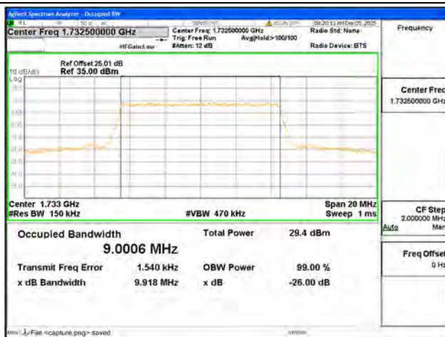
B4 / 10MHz / QPSK/ Mid CH
