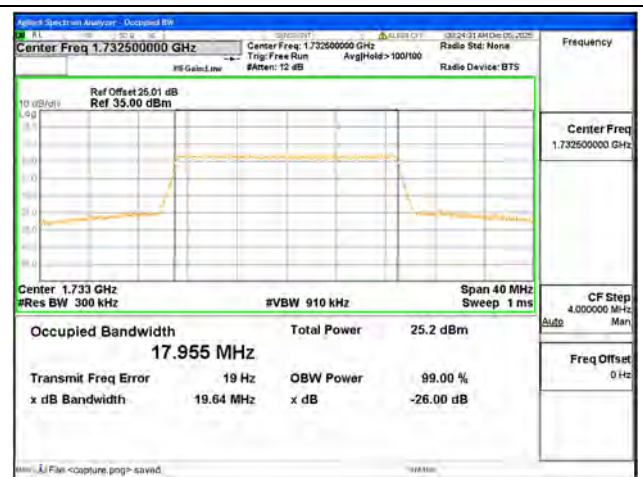
B4 / 20MHz / 256QAM/ Mid CH
