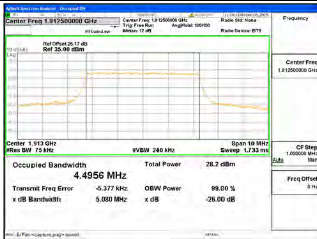
B25 / 5MHz / QPSK/ High CH
