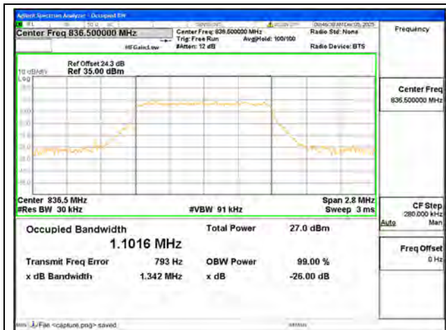
B5 / 1.4MHz / 64QAM/ Mid CH
