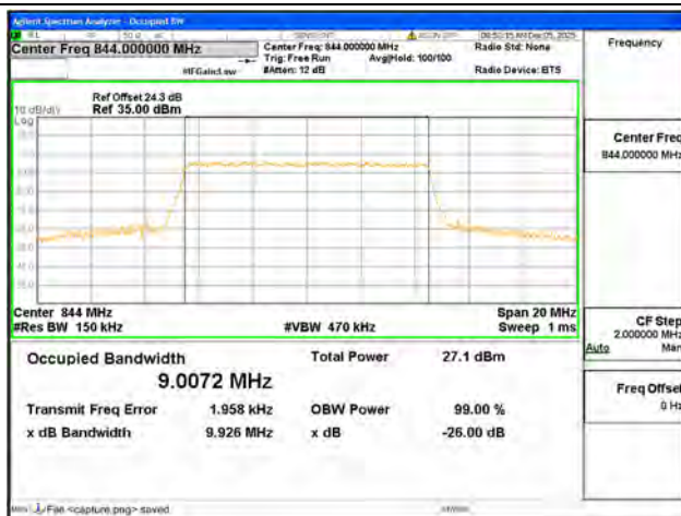
B5 / 10MHz / 64QAM/ High CH
