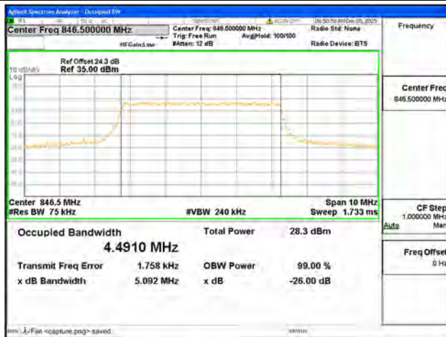
B5 / 5MHz / QPSK/ High CH
