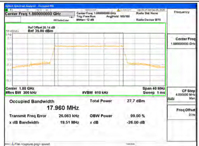
B2 / 20MHz / 16QAM/ Mid CH
