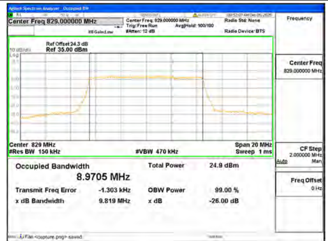
B5 / 10MHz / 256QAM/ Low CH
