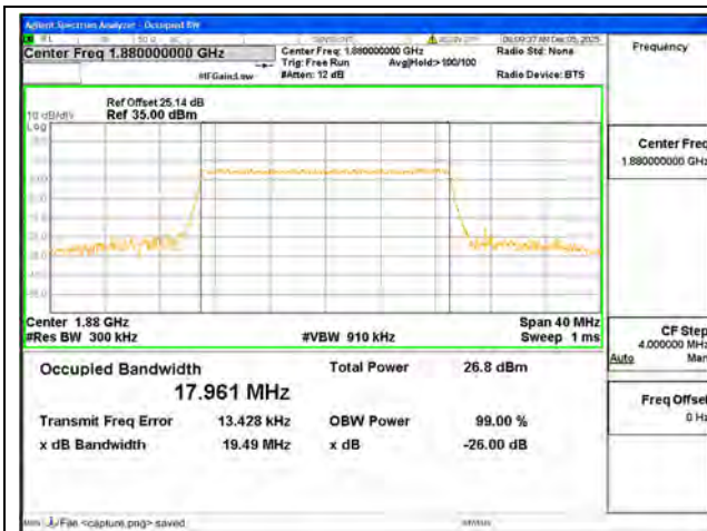
B2 / 20MHz / 64QAM/ Mid CH
