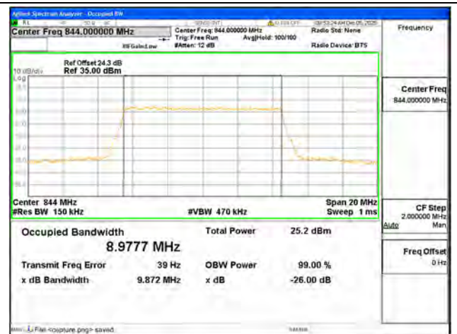
B5 / 10MHz / 256QAM/ High CH
