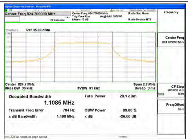
B5 / 1.4MHz / 16QAM/ Low CH
