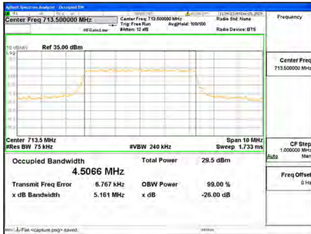
B17 / 5MHz / QPSK/ High CH
