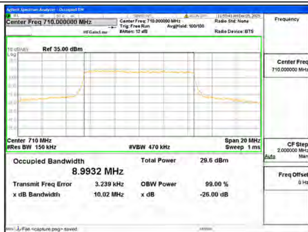
B17 / 10MHz / QPSK/ Mid CH
