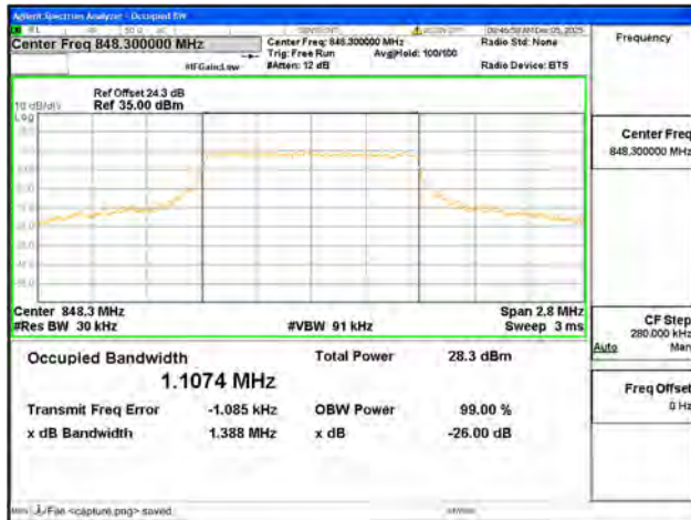
B5 / 1.4MHz / QPSK/ High CH
