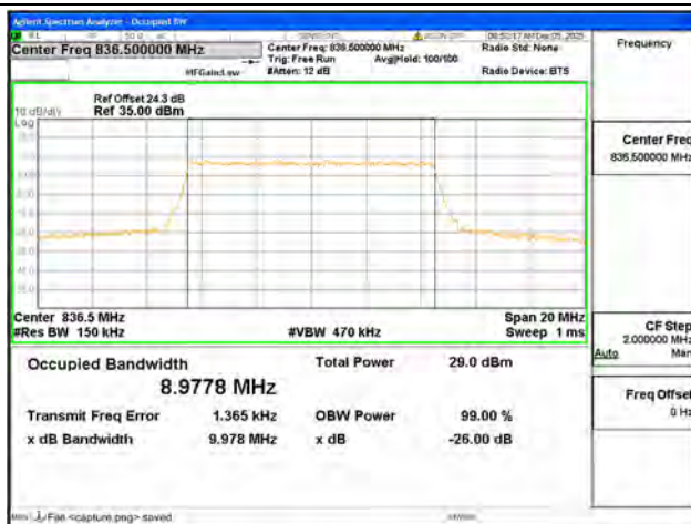
B5 / 10MHz / QPSK/ Mid CH
