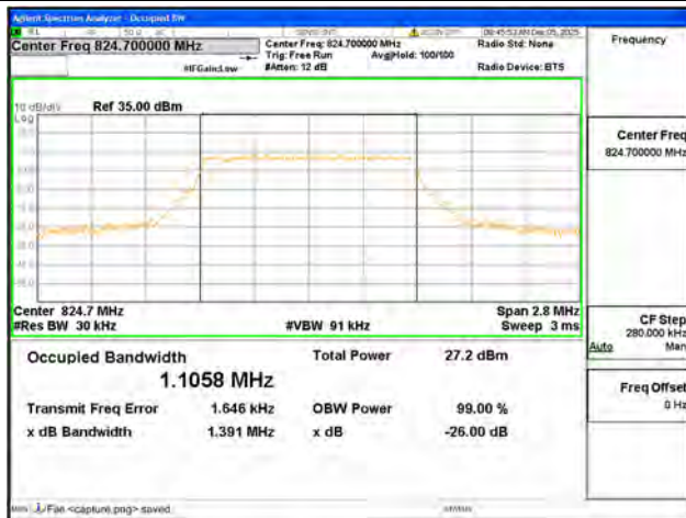
B5 / 1.4MHz / 64QAM/ Low CH
