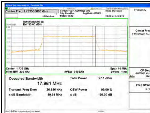
B4 / 20MHz / 64QAM/ Mid CH
