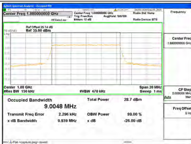
B2 / 10MHz / QPSK/ Mid CH
