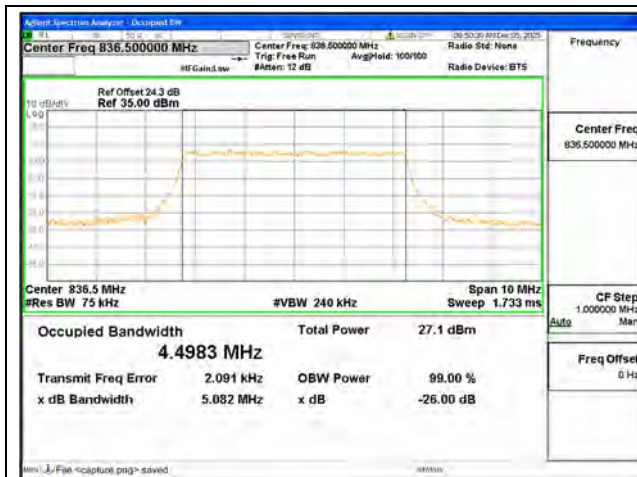
B5 / 5MHz / 64QAM/ Mid CH
