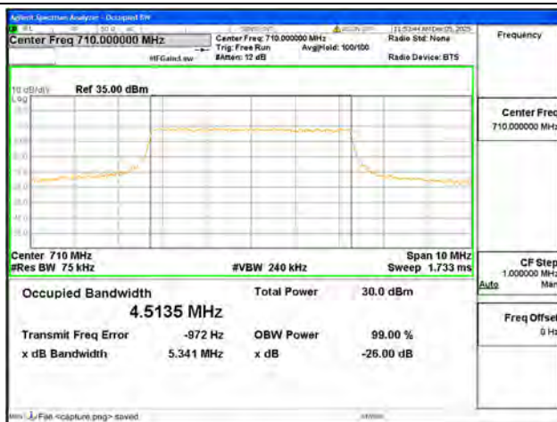
B17 / 5MHz / QPSK/ Mid CH
