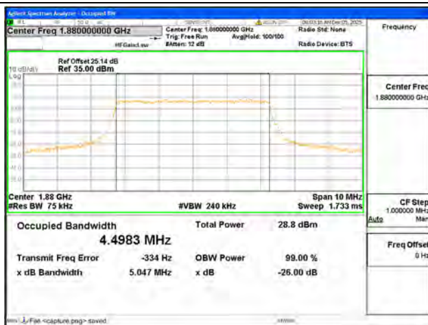
B2 / 5MHz / QPSK/ Mid CH
