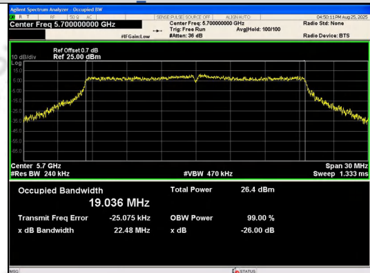
IEEE 802.11ax_Channel 140_20MHz_Antenna 1_RU&amp;Index SU
