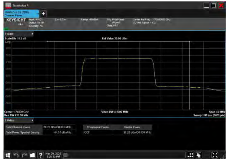
DC_2A_n66A_10MHz|30MHz_15kHz_1905MHz|1765MHz_Q PSK|DFT-s-OFDM PI/2 BPSK_RB1@49|RB1@159
