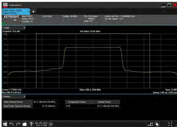
DC_2A_n66A_10MHz|20MHz_15kHz_1905MHz|1770MHz_Q PSK|CP-OFDM QPSK_RB12@38|RB53@26
