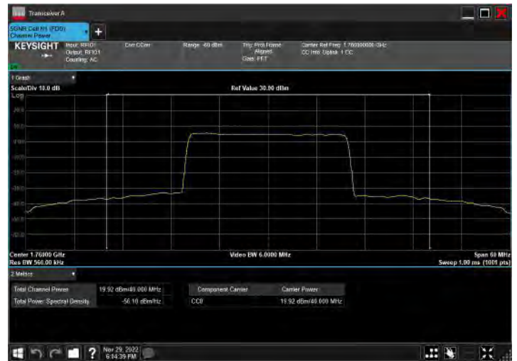
DC_2A_n66A_10MHz|40MHz_15kHz_1905MHz|1760MHz_Q PSK|DFT-s-OFDM QPSK_RB12@38|RB108@54
