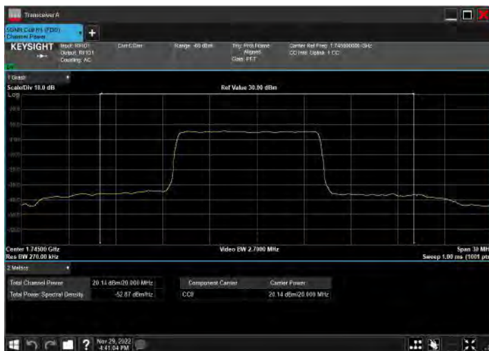
DC_2A_n66A_10MHz|20MHz_15kHz_1880MHz|1745MHz_Q PSK|DFT-s-OFDM QPSK_RB12@0|RB50@25
