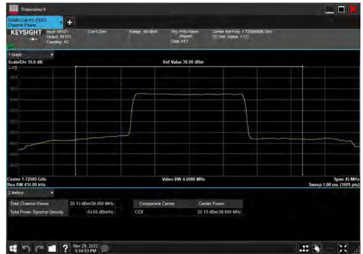
DC_2A_n66A_10MHz|30MHz_15kHz_1855MHz|1725MHz_Q PSK|DFT-s-OFDM QPSK_RB12@0|RB80@40
