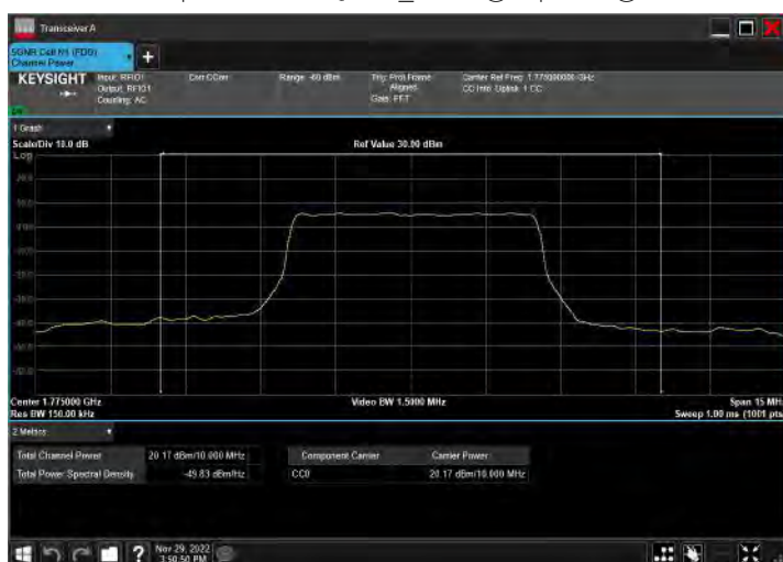
DC_2A_n66A_10MHz|10MHz_15kHz_1905MHz|1775MHz_Q PSK|CP-OFDM QPSK_RB12@38|RB26@13
