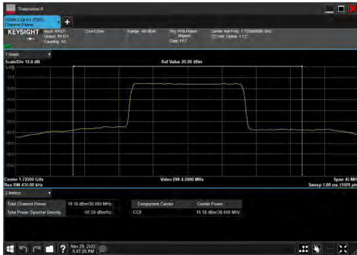
DC_2A_n66A_10MHz|30MHz_15kHz_1855MHz|1725MHz_Q PSK|CP-OFDM QPSK_RB12@0|RB80@40
