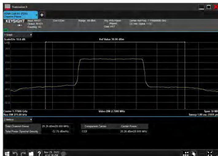
DC_2A_n66A_10MHz|20MHz_15kHz_1905MHz|1770MHz_Q PSK|DFT-s-OFDM QPSK_RB12@38|RB50@25
