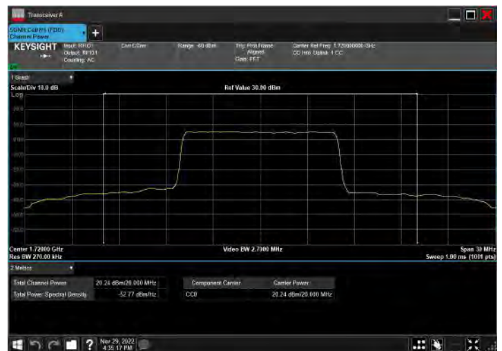
DC_2A_n66A_10MHz|20MHz_15kHz_1855MHz|1720MHz_Q PSK|CP-OFDM QPSK_RB12@0|RB53@26
