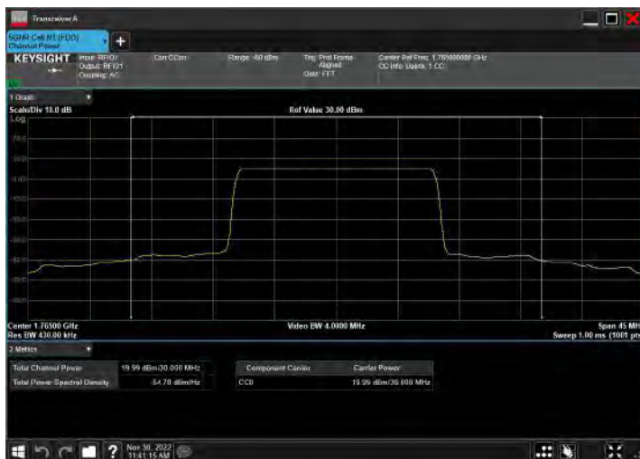
DC_5A_n66A_10MHz|30MHz_15kHz_844MHz|1765MHz_QP SK|DFT-s-OFDM PI/2 BPSK_RB12@38|RB80@40
