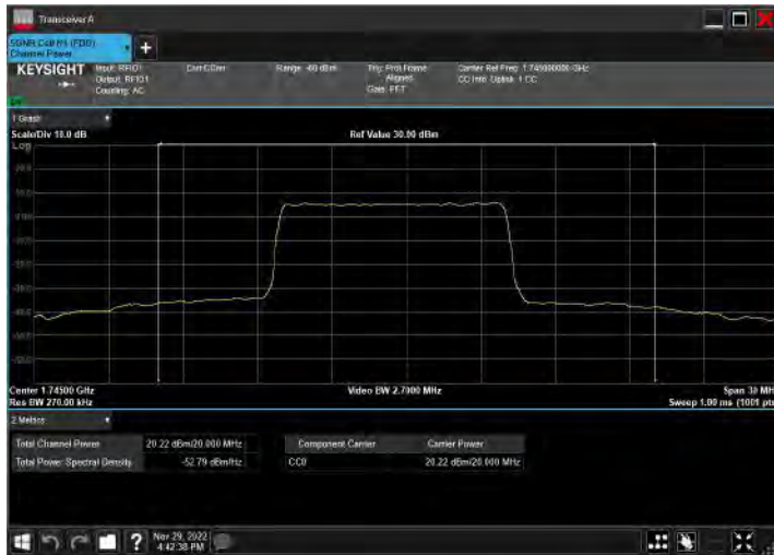
DC_2A_n66A_10MHz|20MHz_15kHz_1880MHz|1745MHz_Q PSK|CP-OFDM QPSK_RB12@0|RB53@26
