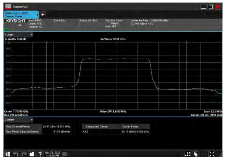
DC_2A_n66A_10MHz|15MHz_15kHz_1880MHz|1745MHz_Q PSK|CP-OFDM QPSK_RB12@0|RB39@19
