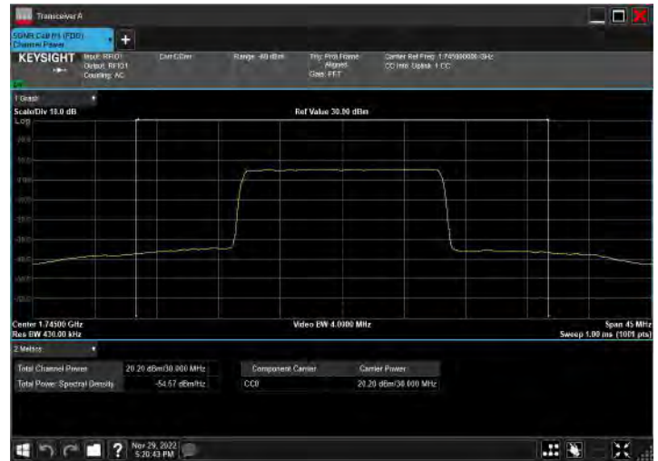
DC_2A_n66A_10MHz|30MHz_15kHz_1905MHz|1765MHz_Q PSK|DFT-s-OFDM PI/2 BPSK_RB1@49|RB1@159
