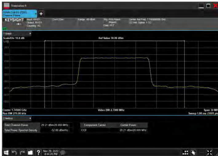
DC_2A_n66A_10MHz|20MHz_15kHz_1880MHz|1745MHz_Q PSK|CP-OFDM QPSK_RB12@0|RB53@26
