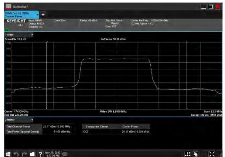
DC_2A_n66A_10MHz|15MHz_15kHz_1880MHz|1745MHz_Q PSK|CP-OFDM QPSK_RB12@0|RB39@19
