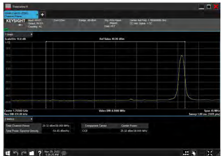
DC_2A_n66A_10MHz|30MHz_15kHz_1905MHz|1765MHz_Q PSK|DFT-s-OFDM QPSK_RB1@49|RB1@159
