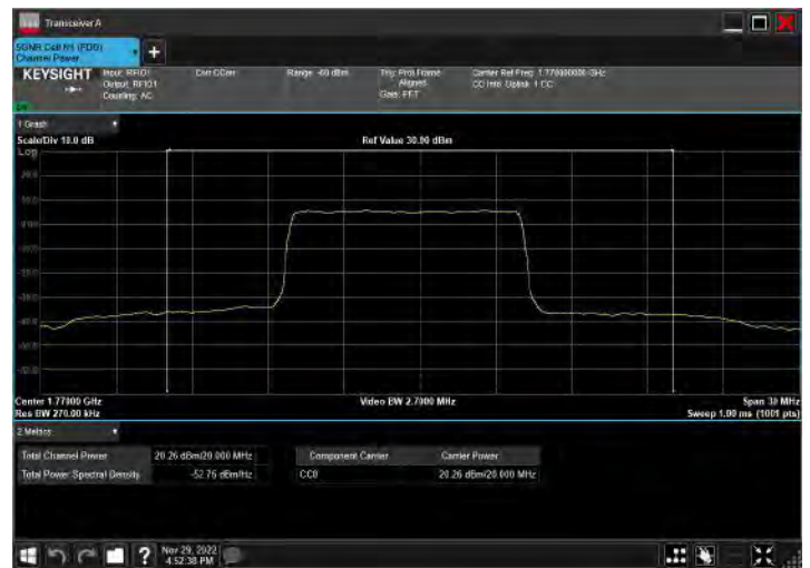
DC_2A_n66A_10MHz|20MHz_15kHz_1905MHz|1770MHz_Q PSK|DFT-s-OFDM QPSK_RB12@38|RB50@25
