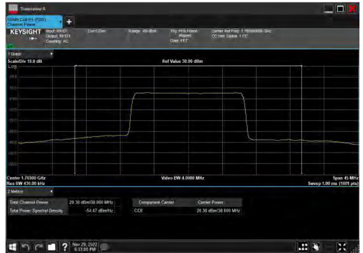
DC_2A_n66A_10MHz|40MHz_15kHz_1855MHz|1730MHz_Q PSK|DFT-s-OFDM PI/2 BPSK_RB1@0|RB1@0
