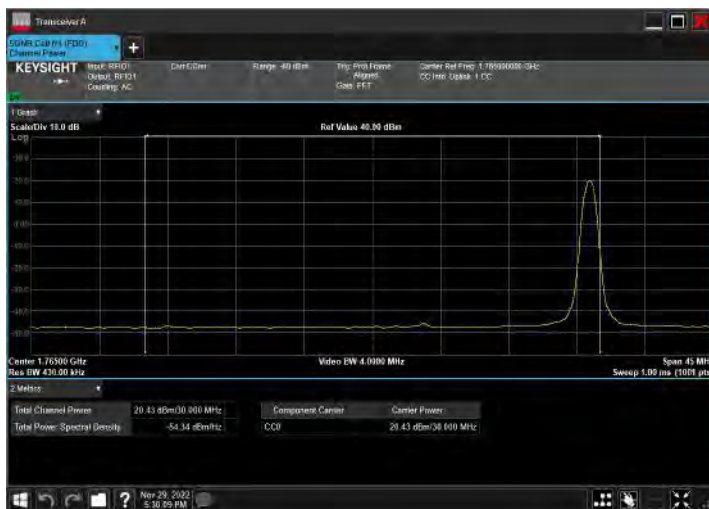
DC_2A_n66A_10MHz|30MHz_15kHz_1905MHz|1765MHz_Q PSK|CP-OFDM QPSK_RB1@49|RB1@159
