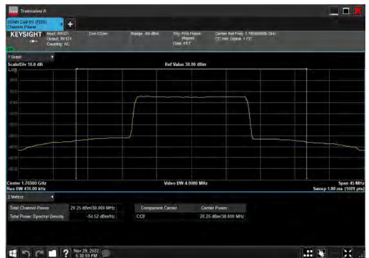
DC_2A_n66A_10MHz|30MHz_15kHz_1905MHz|1765MHz_Q PSK|CP-OFDM QPSK_RB12@38|RB80@40
