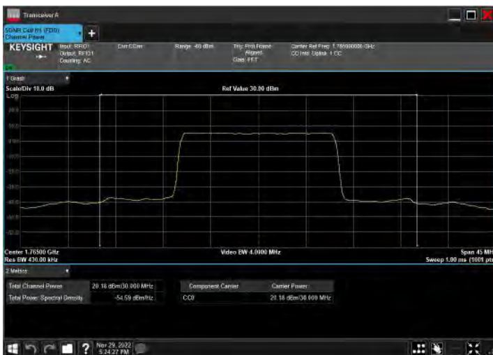
DC_2A_n66A_10MHz|30MHz_15kHz_1905MHz|1765MHz_Q PSK|DFT-s-OFDM PI/2 BPSK_RB12@38|RB80@40
