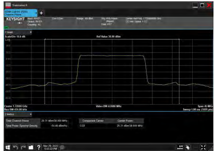
DC_2A_n66A_10MHz|30MHz_15kHz_1855MHz|1725MHz_Q PSK|DFT-s-OFDM QPSK_RB12@0|RB80@40
