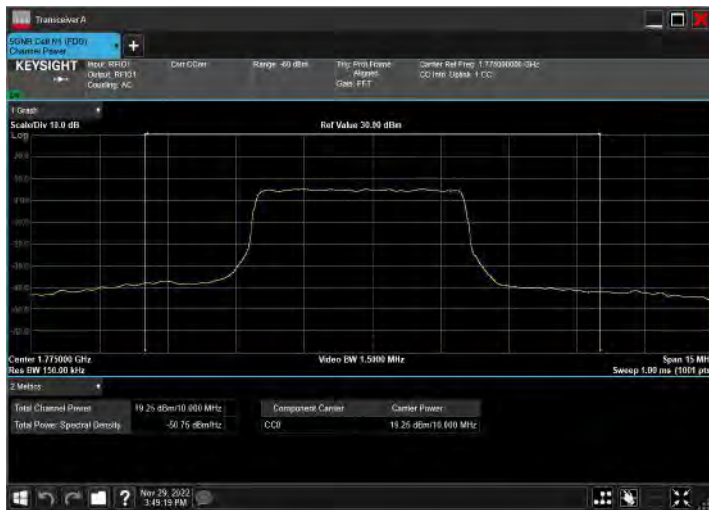
DC_2A_n66A_10MHz|10MHz_15kHz_1905MHz|1775MHz_Q PSK|CP-OFDM QPSK_RB12@38|RB26@13
