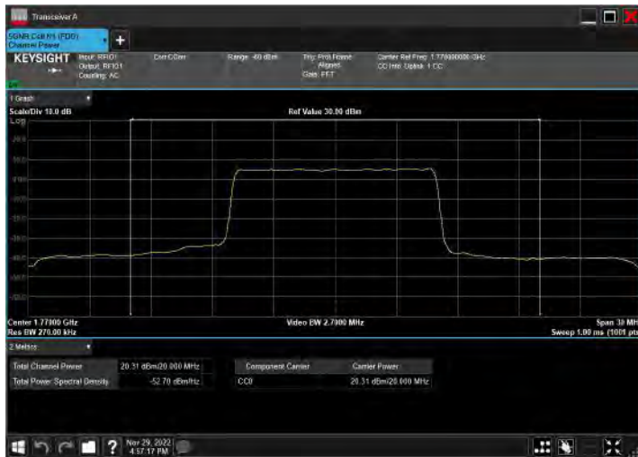
DC_2A_n66A_10MHz|20MHz_15kHz_1905MHz|1770MHz_Q PSK|CP-OFDM QPSK_RB12@38|RB53@26
