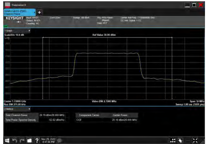
DC_2A_n66A_10MHz|20MHz_15kHz_1880MHz|1745MHz_Q PSK|DFT-s-OFDM PI/2 BPSK_RB12@0|RB50@25
