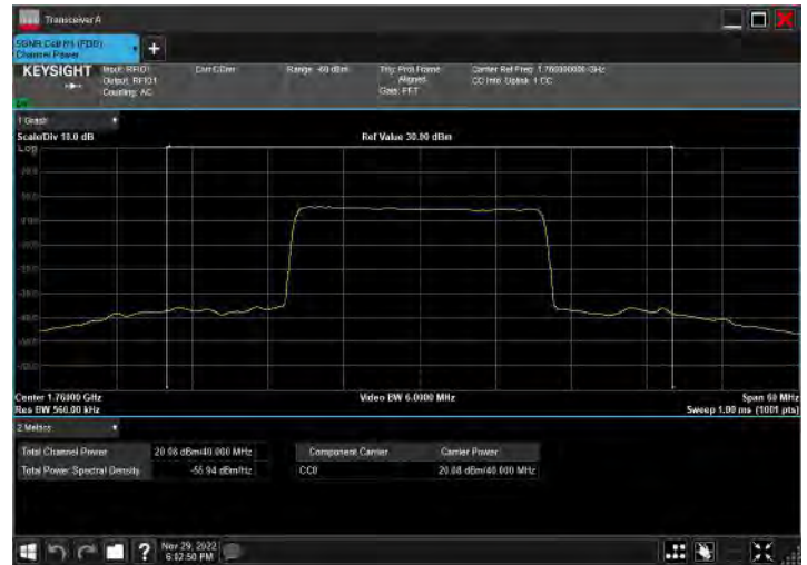
DC_2A_n66A_10MHz|40MHz_15kHz_1905MHz|1760MHz_Q PSK|DFT-s-OFDM QPSK_RB12@38|RB108@54
