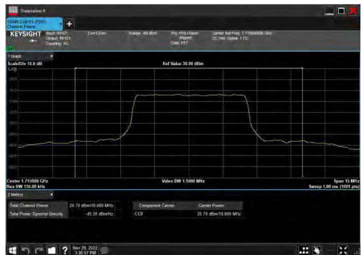
DC_2A_n66A_10MHz|10MHz_15kHz_1855MHz|1715MHz_Q PSK|CP-OFDM QPSK_RB12@0|RB26@13
