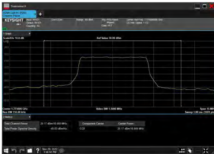
DC_2A_n66A_10MHz|10MHz_15kHz_1905MHz|1775MHz_Q PSK|CP-OFDM QPSK_RB12@38|RB26@13
