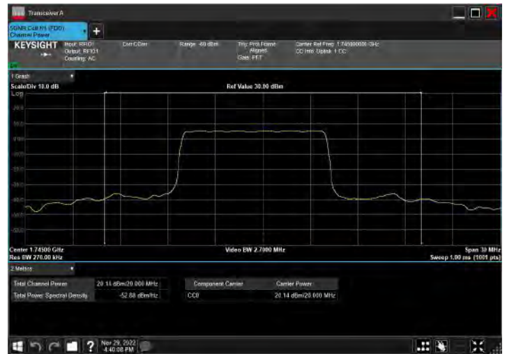
DC_2A_n66A_10MHz|20MHz_15kHz_1880MHz|1745MHz_Q PSK|DFT-s-OFDM PI/2 BPSK_RB12@0|RB50@25
