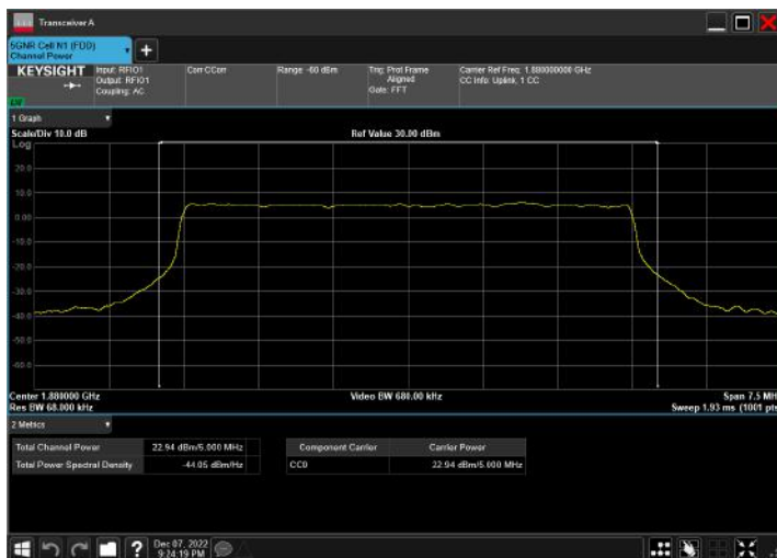
n2_5MHz_15kHz_1880MHz_DFT-s-OFDM PI/2 BPSK_RB25@0
