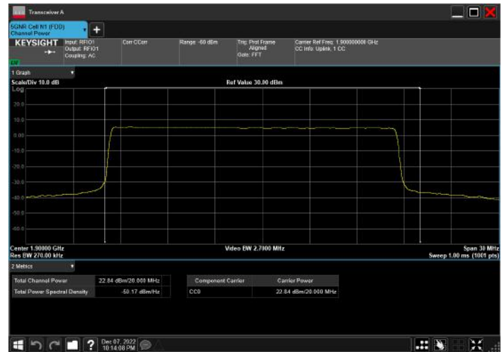
n2_20MHz_15kHz_1900MHz_DFT-s-OFDM PI/2 BPSK_RB100@0
