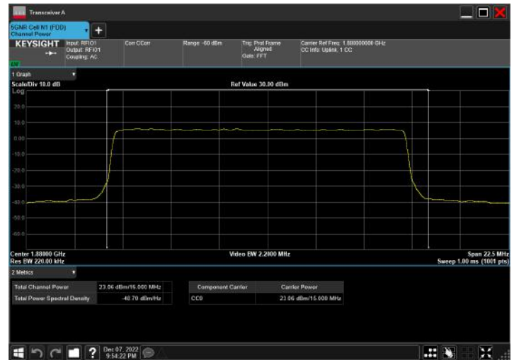
n2_15MHz_15kHz_1880MHz_DFT-s-OFDM PI/2 BPSK_RB75@0
