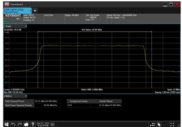
n2_10MHz_15kHz_1855MHz_DFT-s-OFDM PI/2 BPSK_RB50@0
