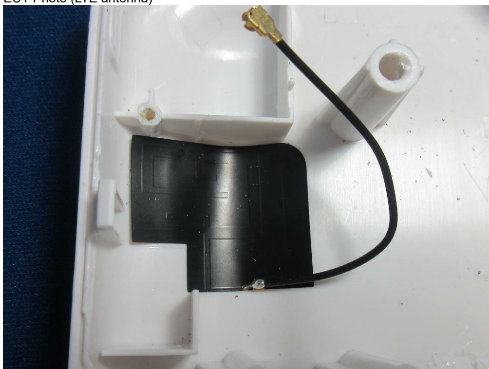
(12) EUT Photo (LTE antenna)
