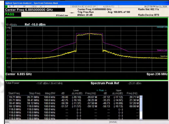
IEEE 802.11ax_Channel 187_40MHz_Antenna 0_RU&Index SU
