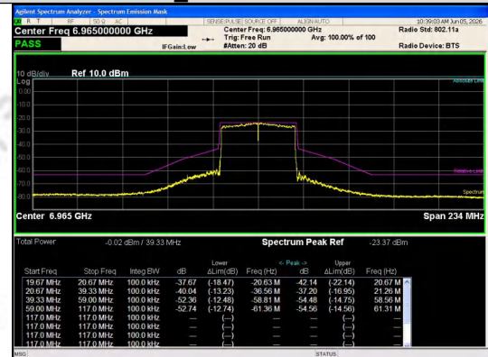
IEEE 802.11ax_Channel 187_40MHz_Antenna 0_RU&Index SU
