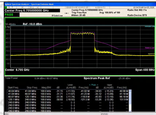
IEEE 802.11ax_Channel 151_80MHz_Antenna 0_RU&Index SU
