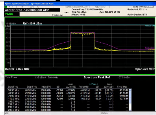
IEEE 802.11ax_Channel 215_80MHz_Antenna 0_RU&Index SU
