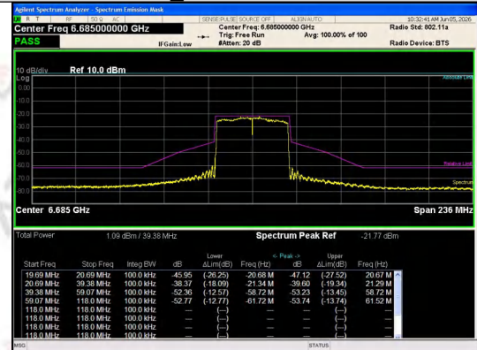
IEEE 802.11ax_Channel 147_40MHz_Antenna 0_RU&Index SU
