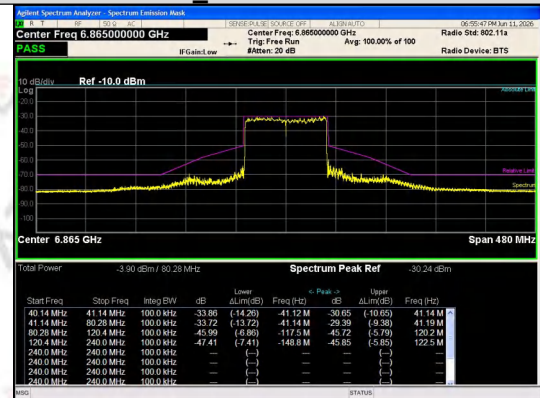
IEEE 802.11ax_Channel 183_80MHz_Antenna 0_RU&Index SU
