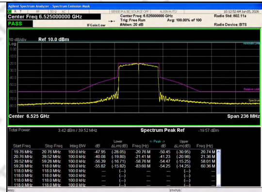
IEEE 802.11ax_Channel 115_40MHz_Antenna 0_RU&Index SU
