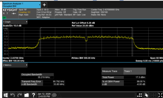
IEEE 802.11n_Channel 6_40MHz_Antenna 0
