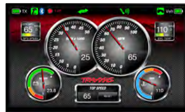
Le tableau de bord personnalisable de Traxxas Link affiche en temps réel les RPM, la vitesse, la température et la tension.
