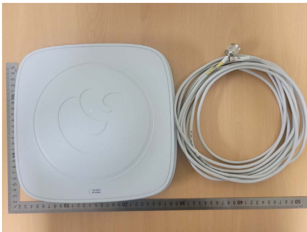
RFID Antenna (M/N: IDRO260-915)
