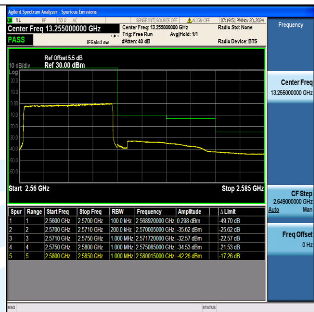
Band7 10MHz QPSK 21400 50RB#0
