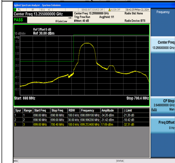
Band12 1.4MHz 64QAM 23017 1RB#0
