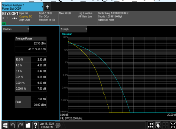
B2 20M QPSK 100@0 CH 18700
