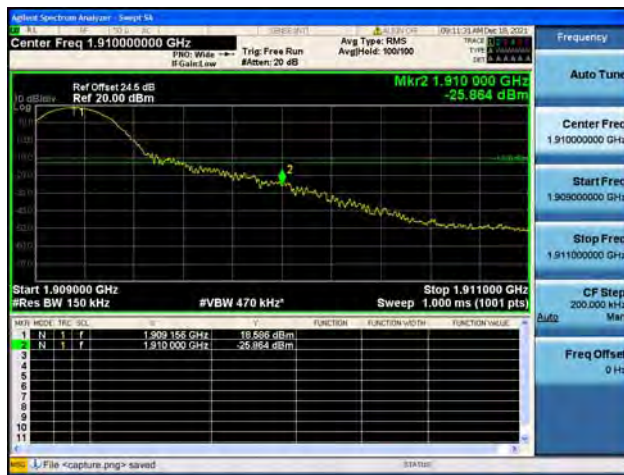
Band2 / 15MHz / High CH / QPSK / 1 RB
