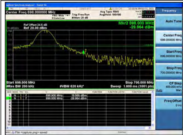
Band71 / 20MHz / High CH / QPSK / 1 RB
