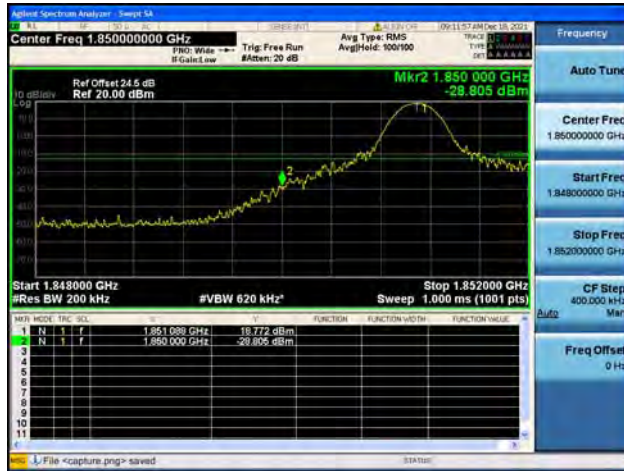
Band2 / 20MHz / High CH / QPSK / 1 RB
