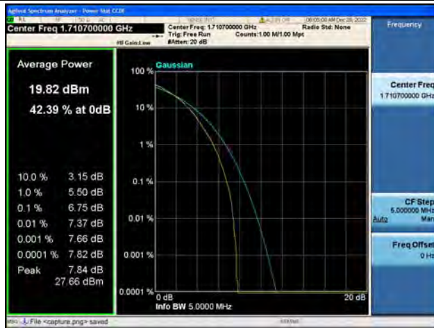
Band4 / 1.4MHz / Low CH / 64QAM
