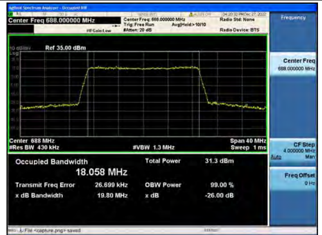
Band71 / 20MHz / QPSK/ High CH
