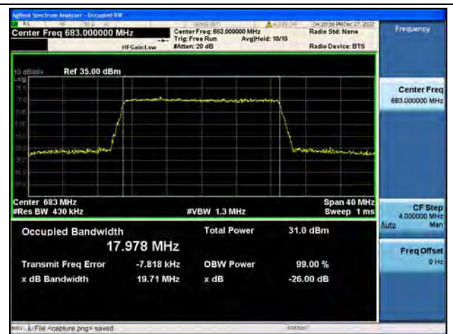
Band71 / 20MHz / 16QAM/ Mid CH
