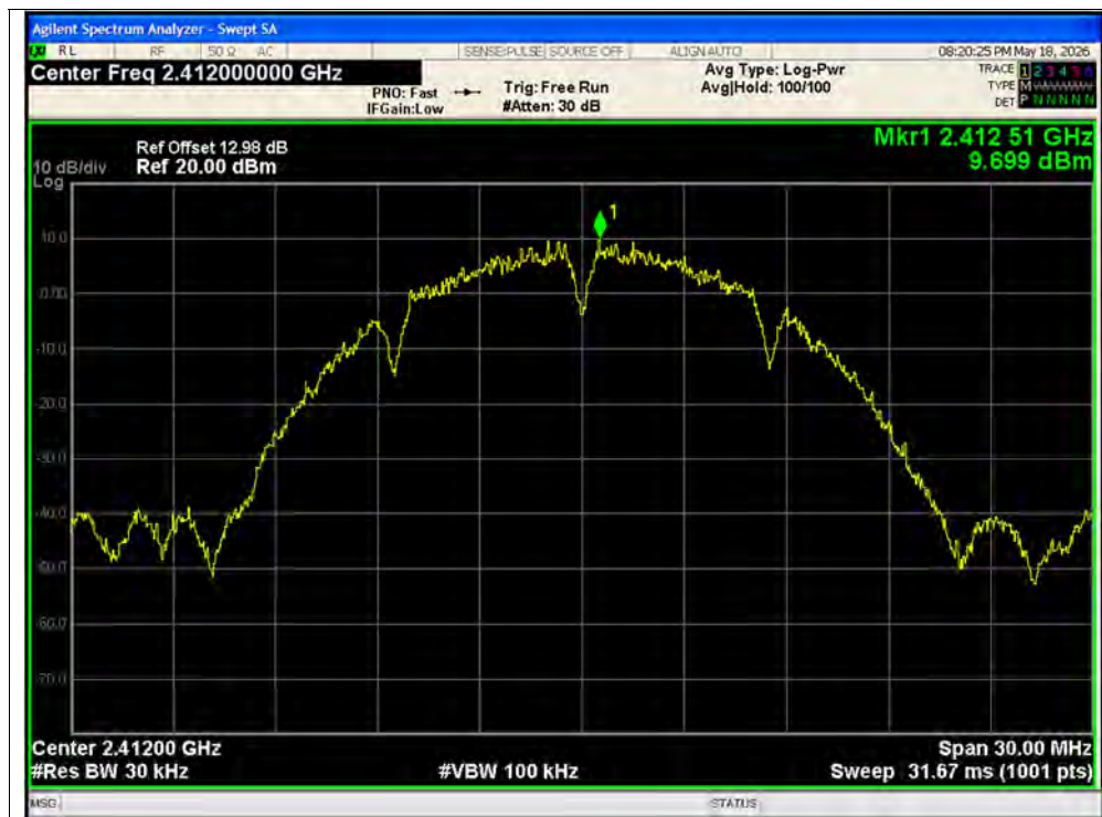
PSD NVNT b 2412MHz Ant1
