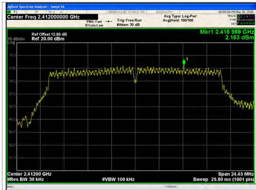
PSD NVNT ac20 2412MHz Ant1
