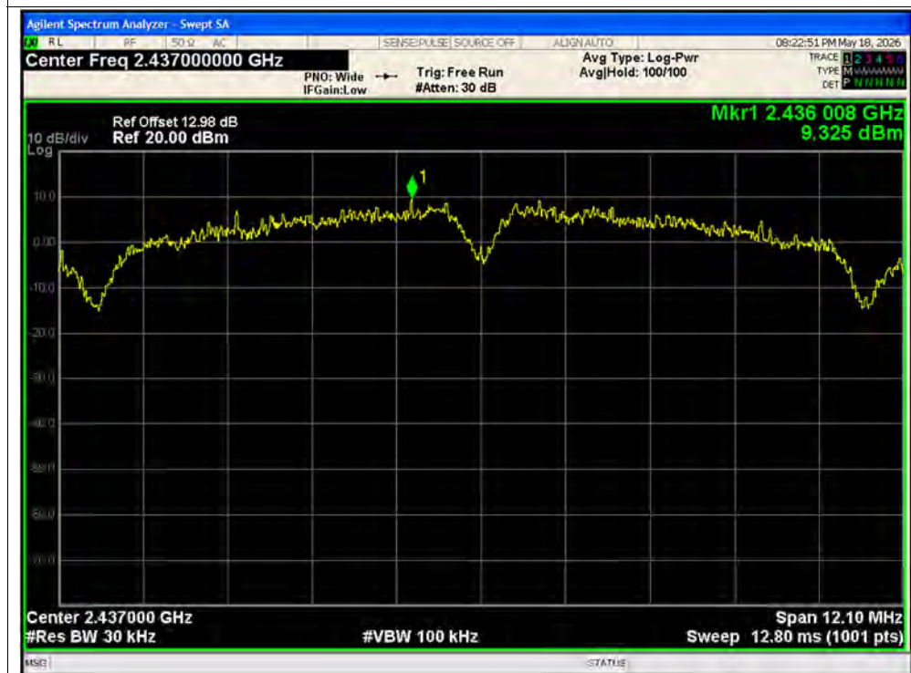
PSD NVNT b 2437MHz Ant1
