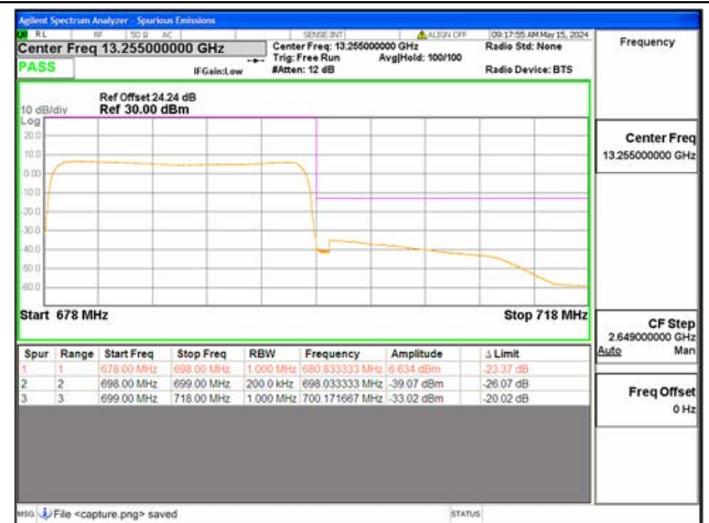
B71 / 20MHz / High CH / QPSK / FULL RB
