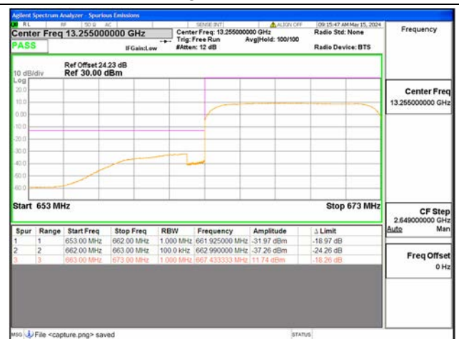
B71 / 10MHz / Low CH / QPSK / FULL RB
