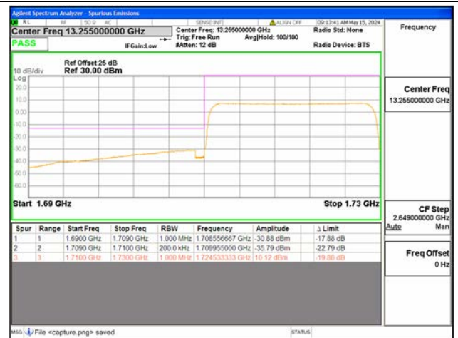
B66 / 20MHz / Low CH / QPSK / FULL RB
