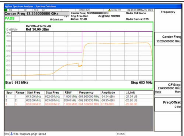
B71 / 20MHz / Low CH / QPSK / FULL RB
