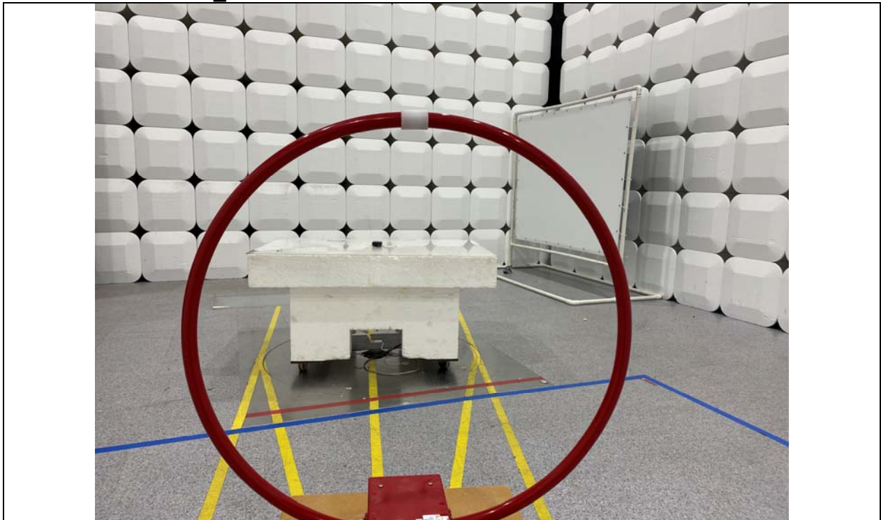
Test distance : 3 m, height of table : 0.8 m
