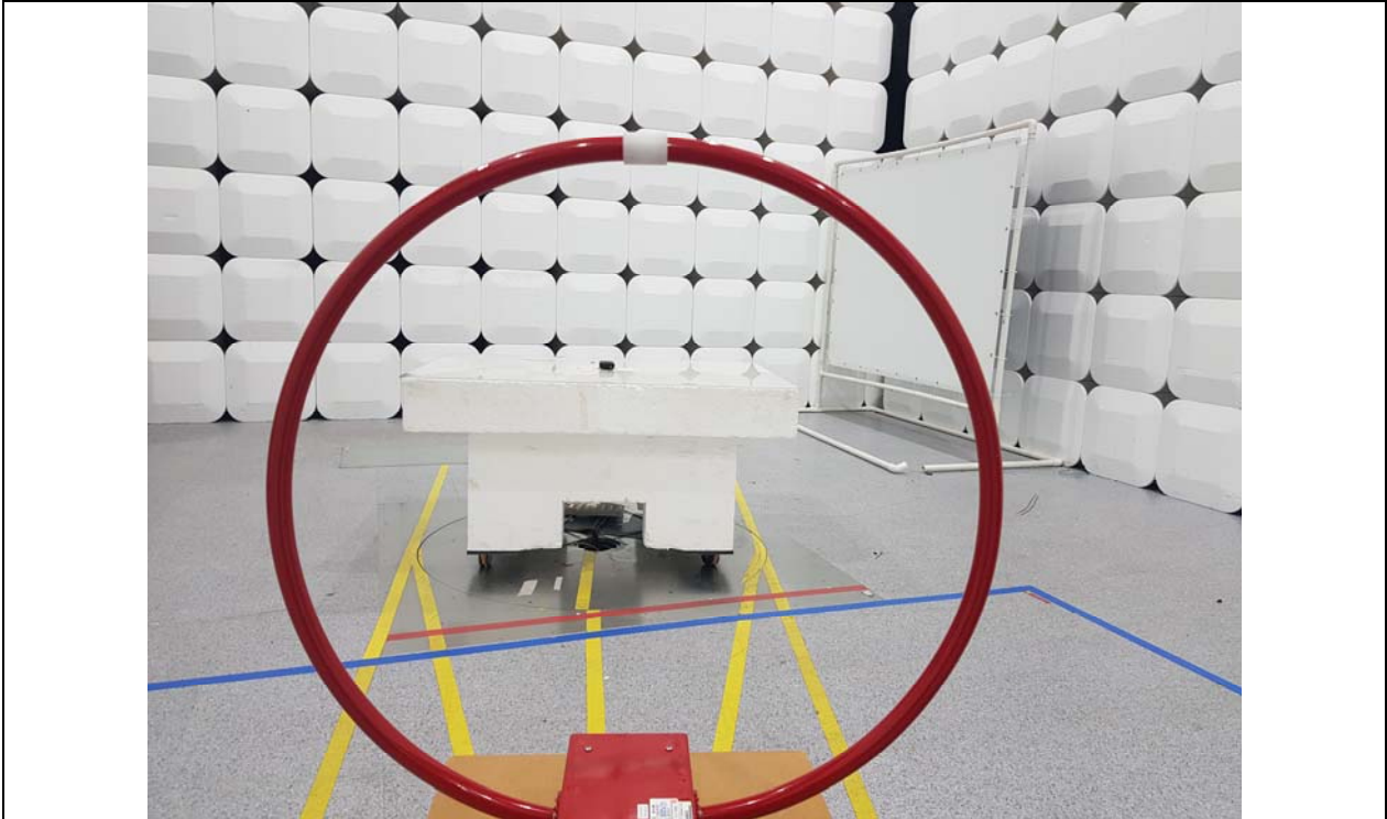
Test distance : 3 m, height of table : 0.8 m
