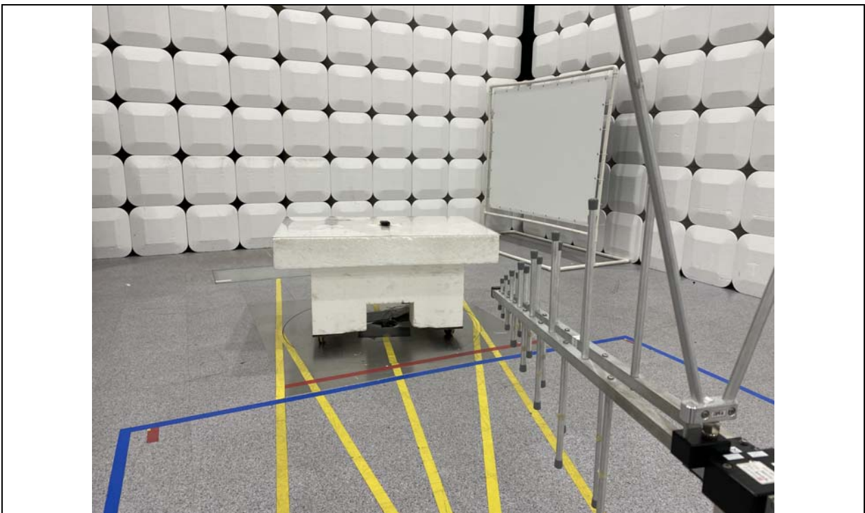
Test distance : 3 m, height of table : 0.8 m
