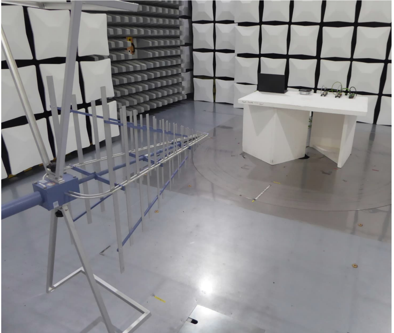
30 MHz - 1 GHz, EUT position 2
