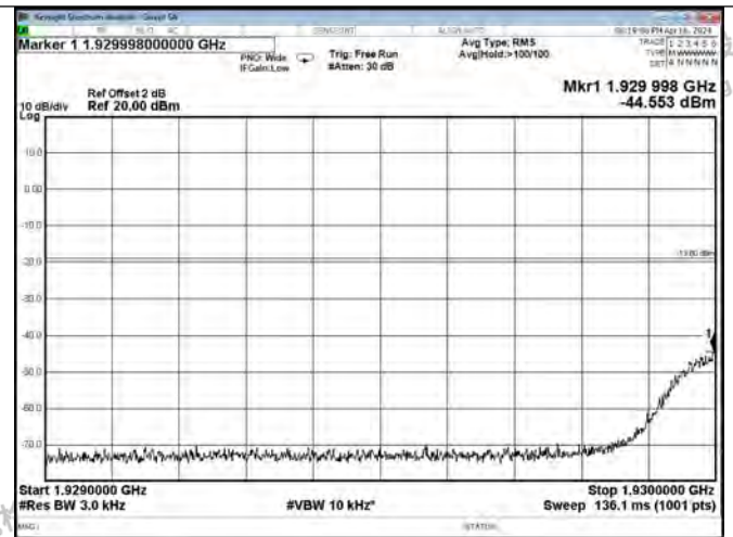
PCS Band DL-GSM Left Side AGC+10dB
