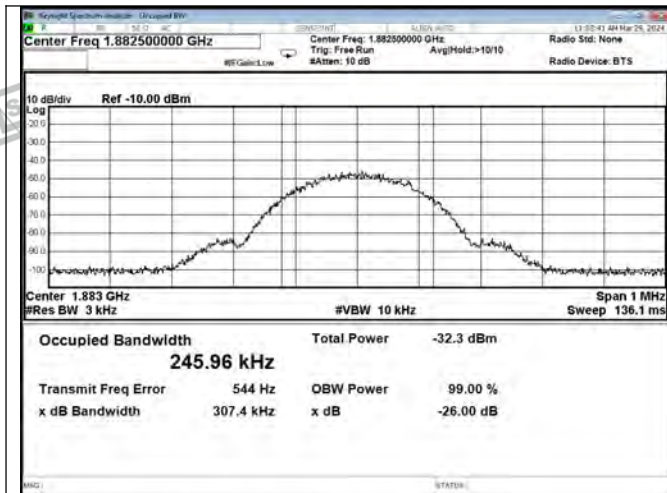
GSM-PCS Band UL Input
