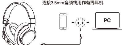
连接3.5mm音频线用作有线耳机
