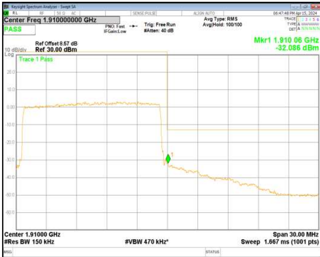
Band2 QPSK BW=20MHz Channel=18700 RB Size=100 Position=#0
