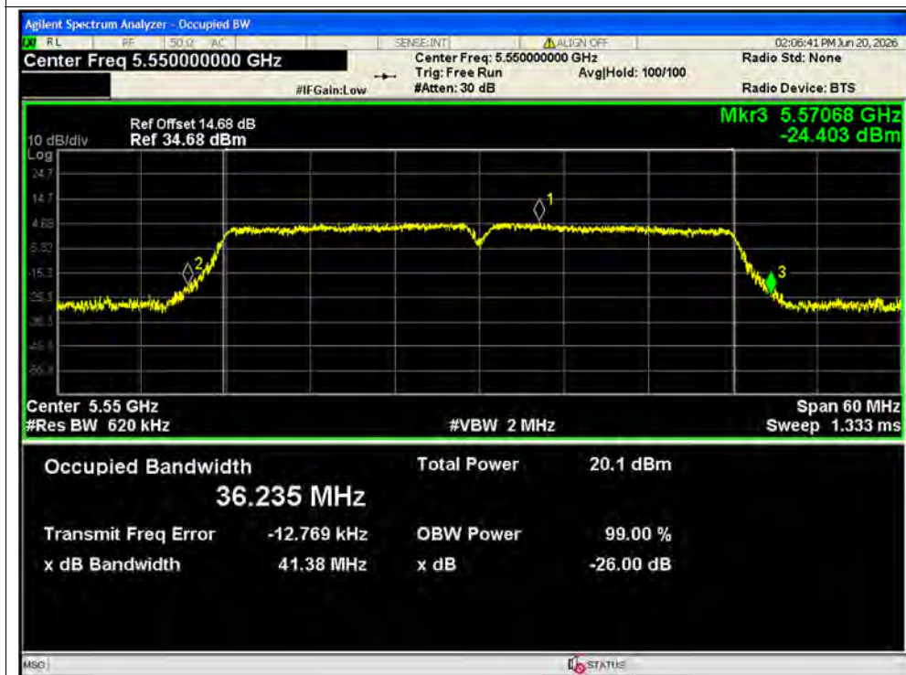
-26dB Bandwidth NVNT n40 5550MHz Ant1
