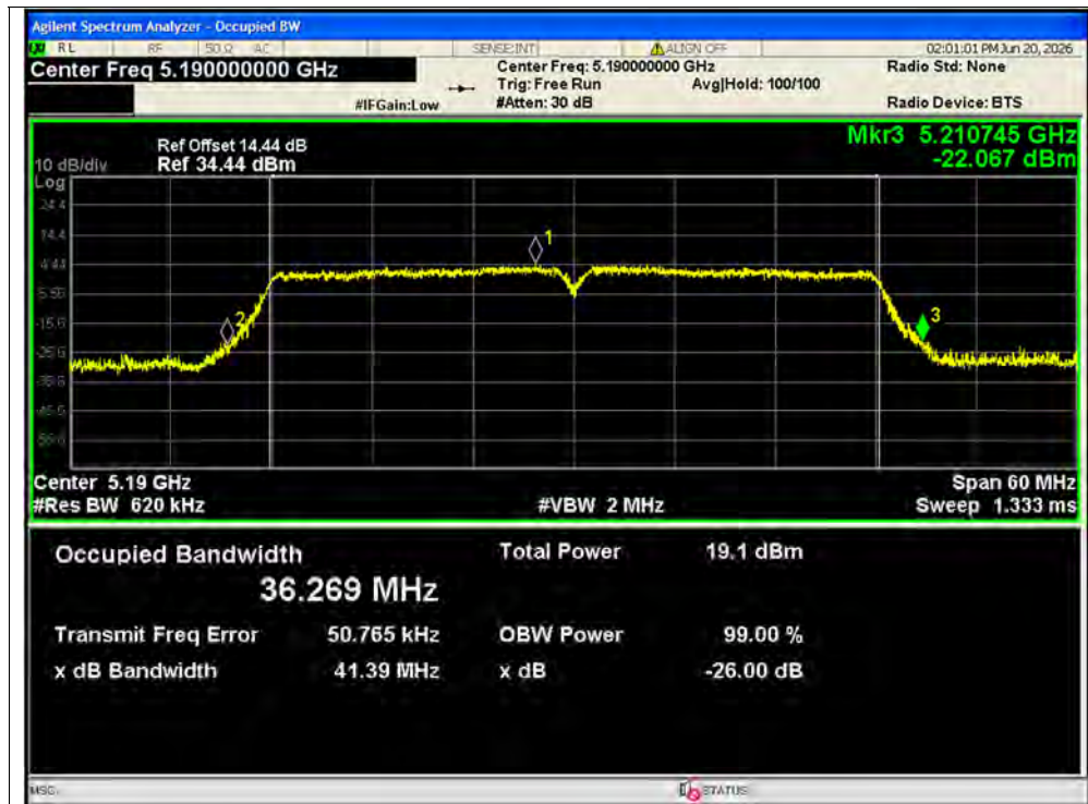
-26dB Bandwidth NVNT n40 5190MHz Ant1
