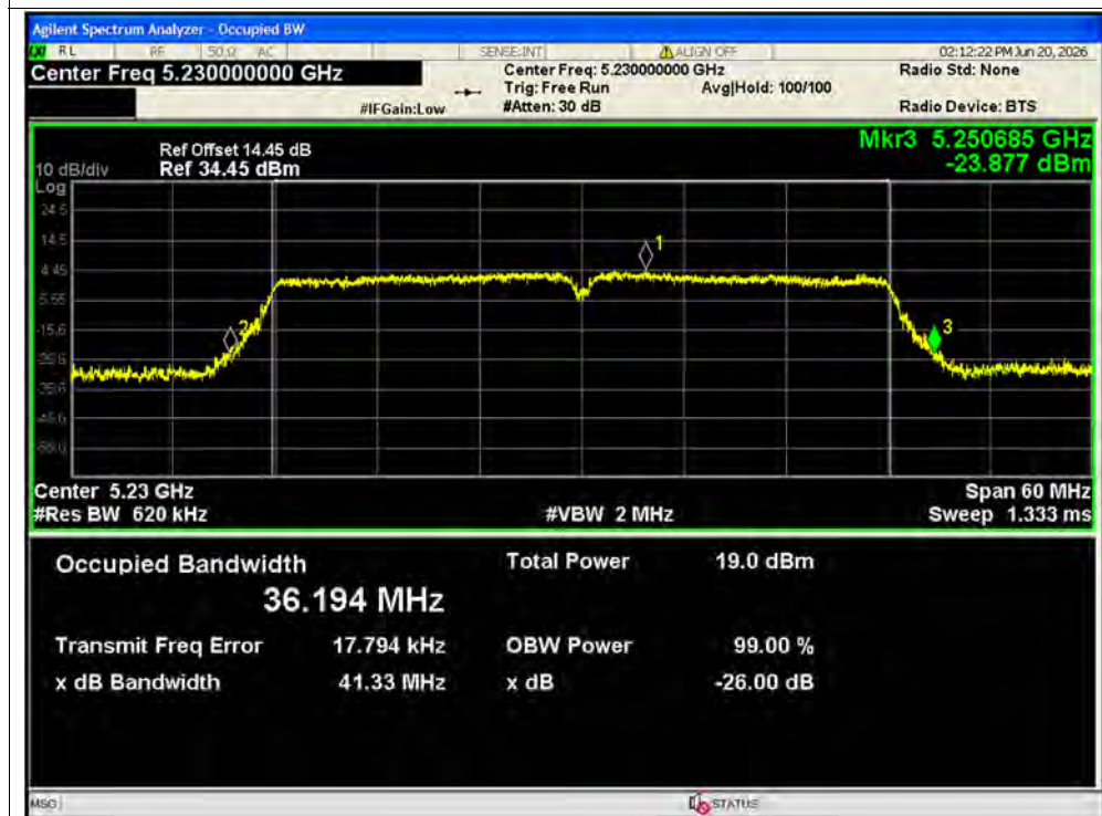
-26dB Bandwidth NVNT ac40 5230MHz Ant1
