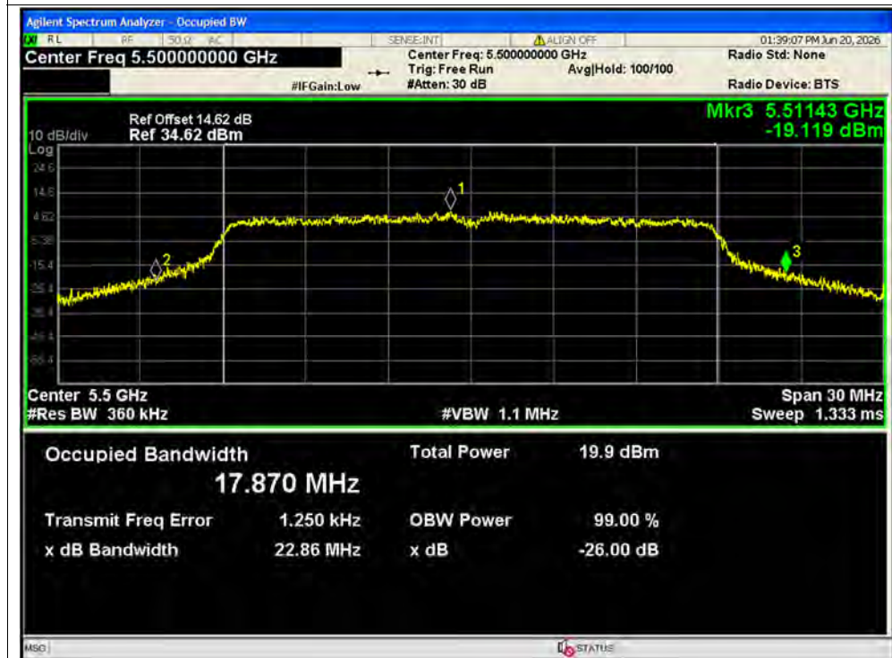
-26dB Bandwidth NVNT n20 5500MHz Ant1
