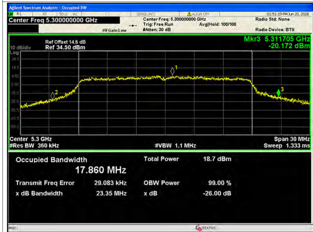
-26dB Bandwidth NVNT ac20 5300MHz Ant1
