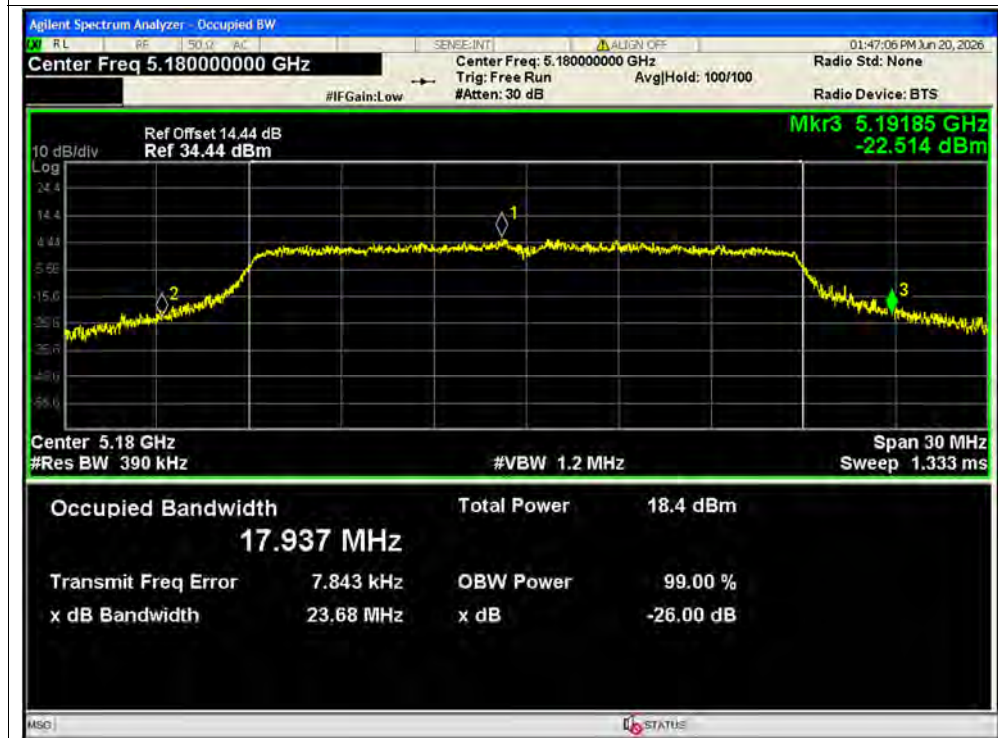
-26dB Bandwidth NVNT ac20 5180MHz Ant1
