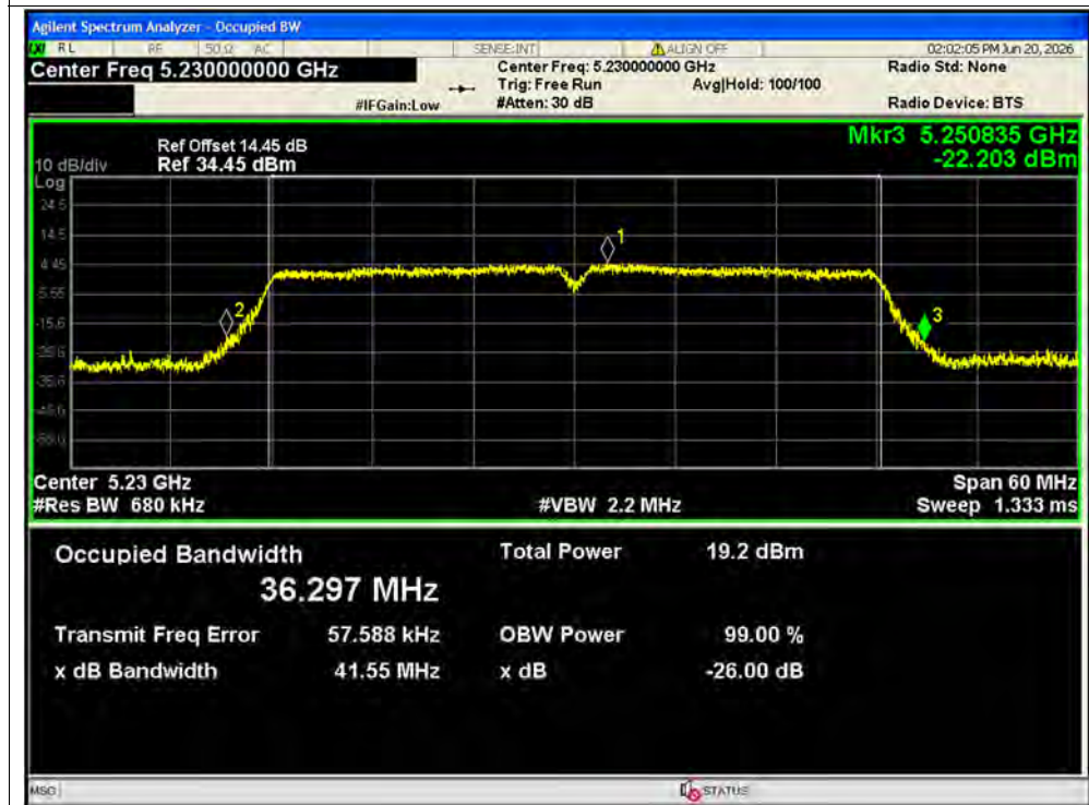
-26dB Bandwidth NVNT n40 5230MHz Ant1
