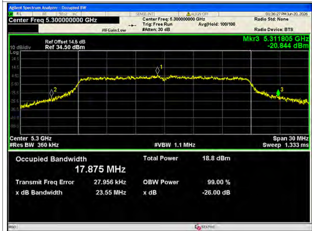
-26dB Bandwidth NVNT n20 5300MHz Ant1
