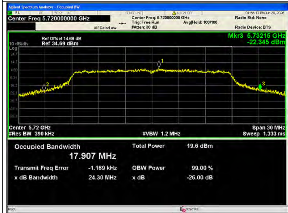
-26dB Bandwidth NVNT ac20 5720MHz Ant1
