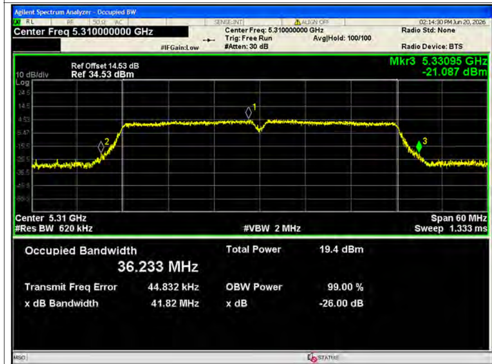
-26dB Bandwidth NVNT ac40 5310MHz Ant1
