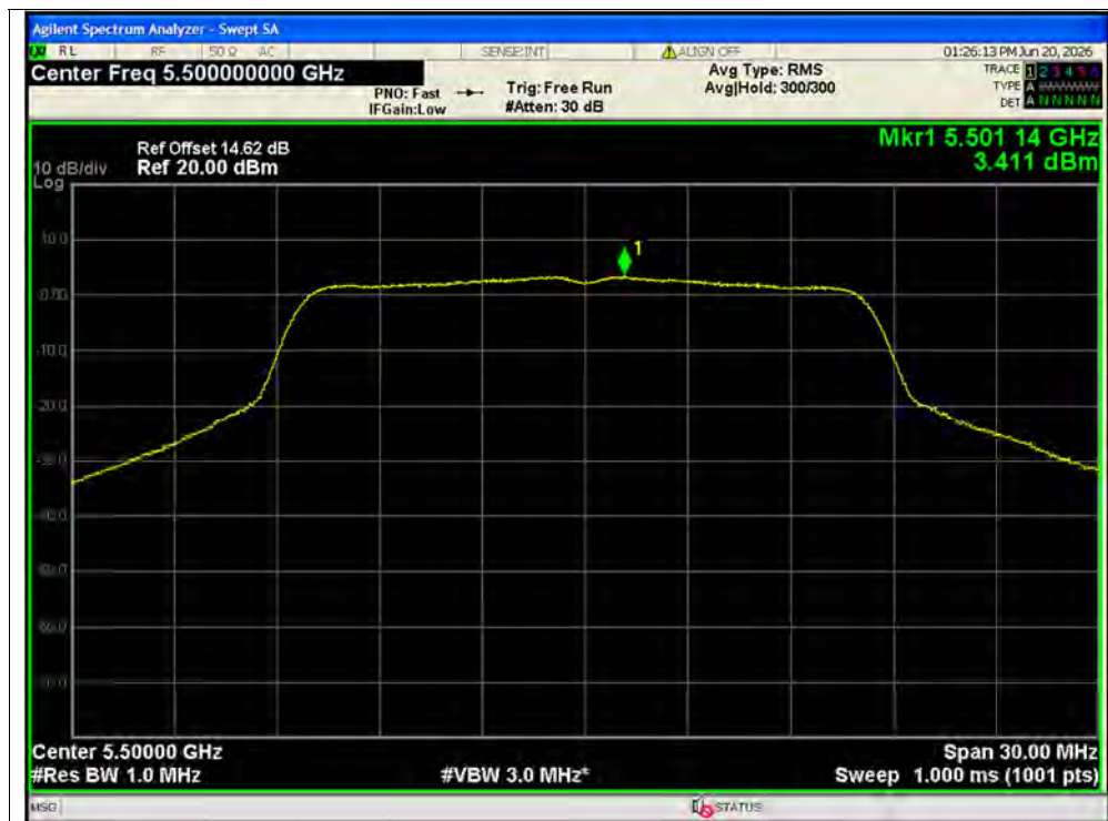
PSD NVNT a 5500MHz Ant1
