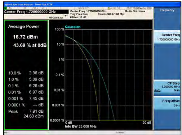
Band4 / 20MHz / Mid CH / 16QAM
