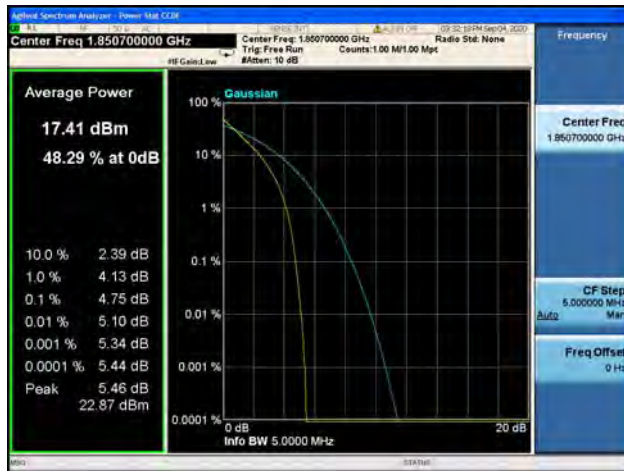
Band2 / 1.4MHz / Mid CH / QPSK
