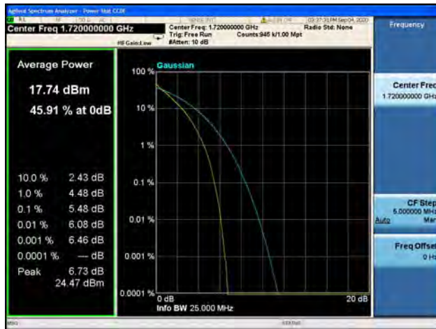
Band4 / 20MHz / Mid CH / QPSK
