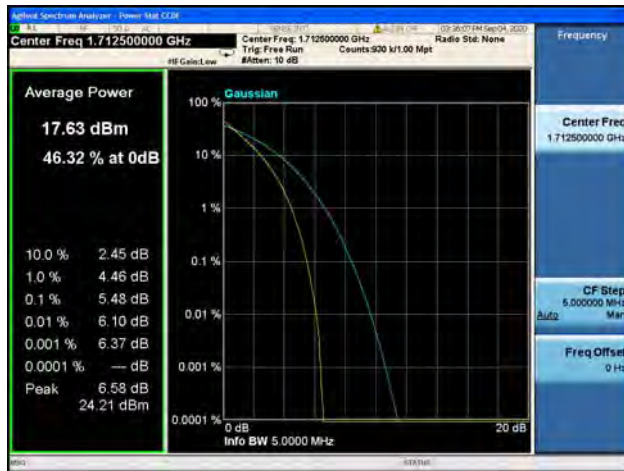
Band4 / 5MHz / Mid CH / QPSK
