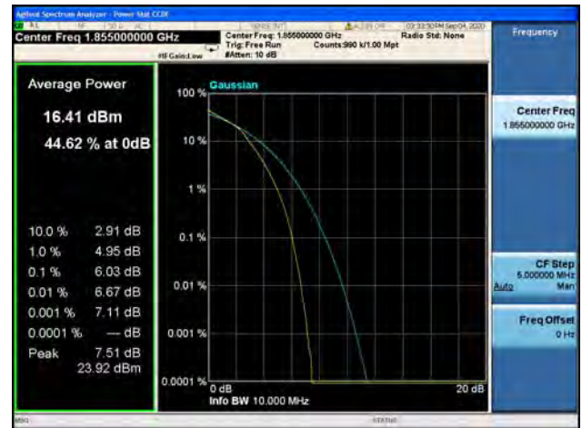
Band2 / 10MHz / Mid CH / 16QAM
