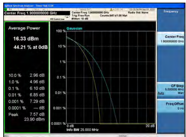
Band2 / 20MHz / High CH / 16QAM
