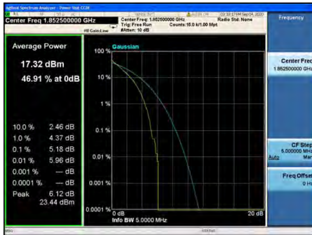
Band2 / 5MHz / Mid CH / QPSK
