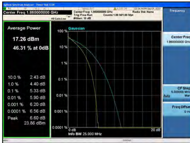
Band2 / 20MHz / Mid CH / QPSK
