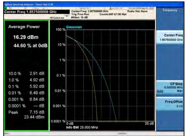
Band2 / 15MHz / Mid CH / 16QAM
