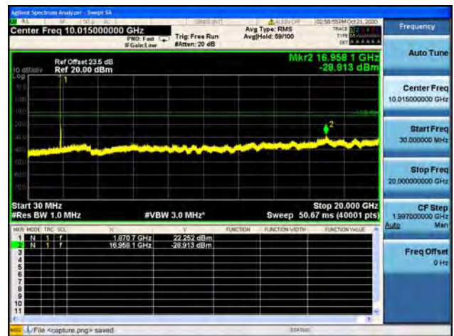
Band2 / 20MHz / High CH / 16QAM
