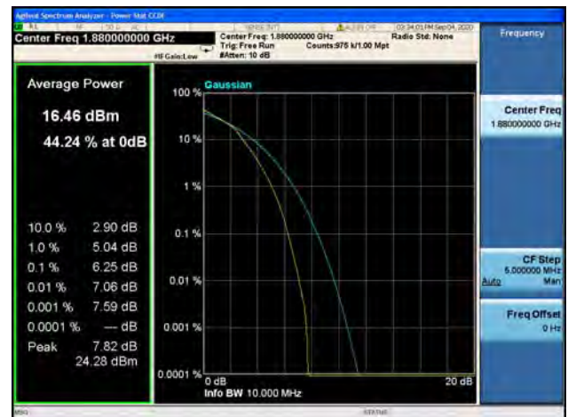
Band2 / 10MHz / High CH / 16QAM
