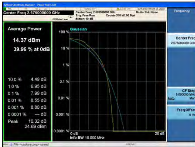
Band38 / 10MHz / Mid CH / QPSK
