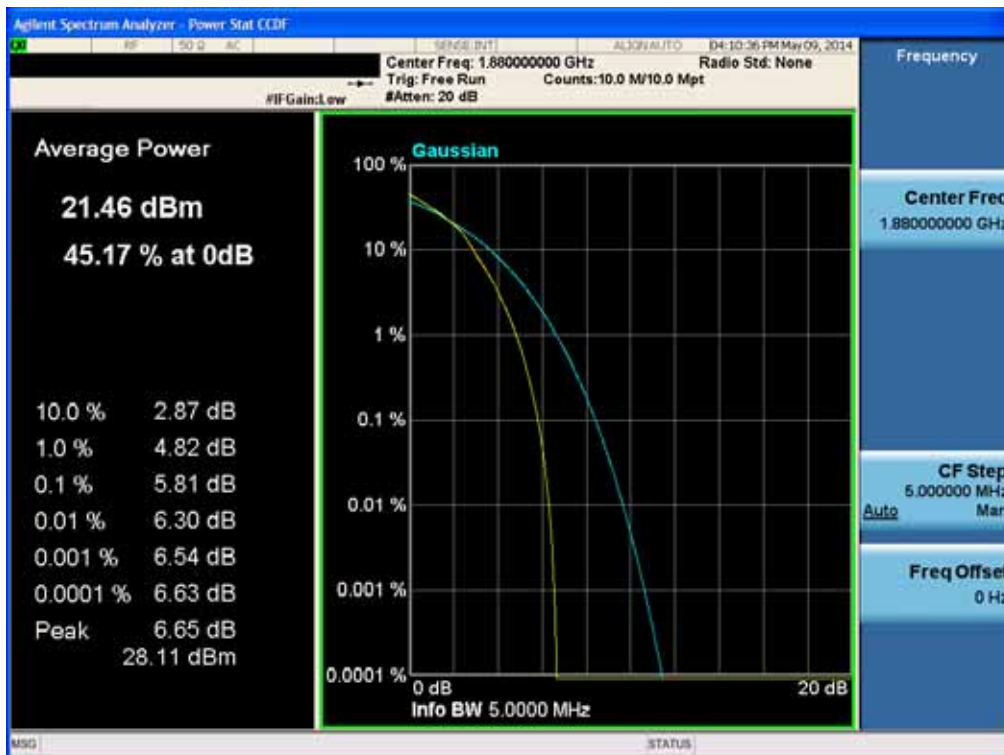
BAND 2. PAR Plot (5M BW Ch.18900 16QAM RB 25_0)
