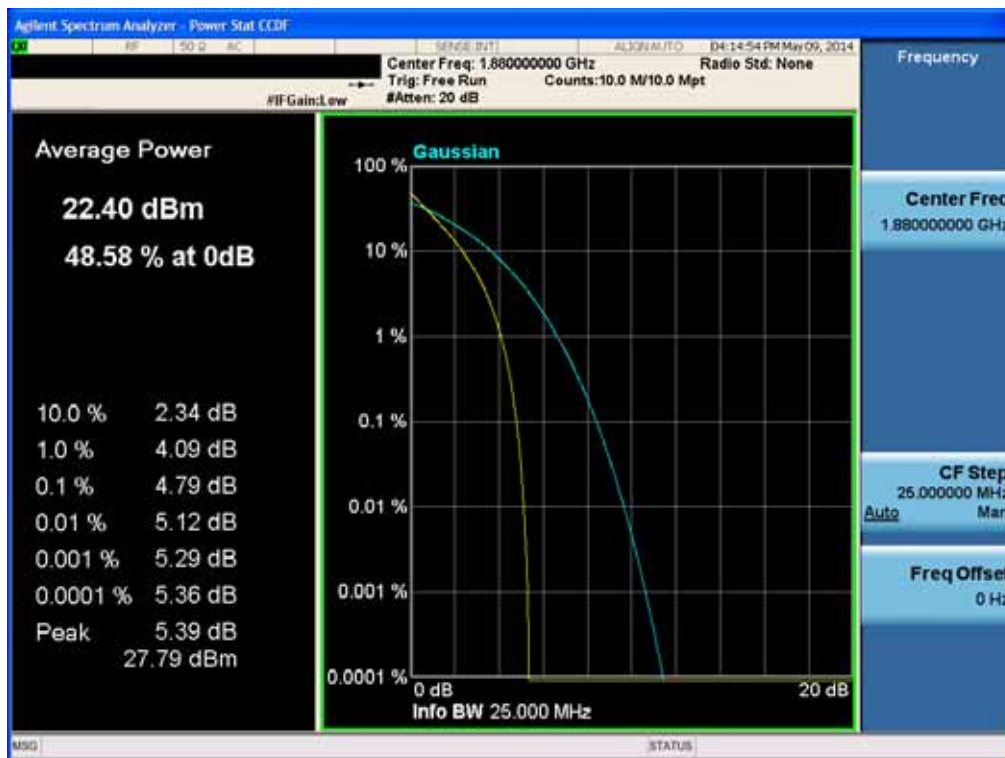
BAND 2. PAR Plot (15M BW Ch.18900 QPSK RB 75_0)
