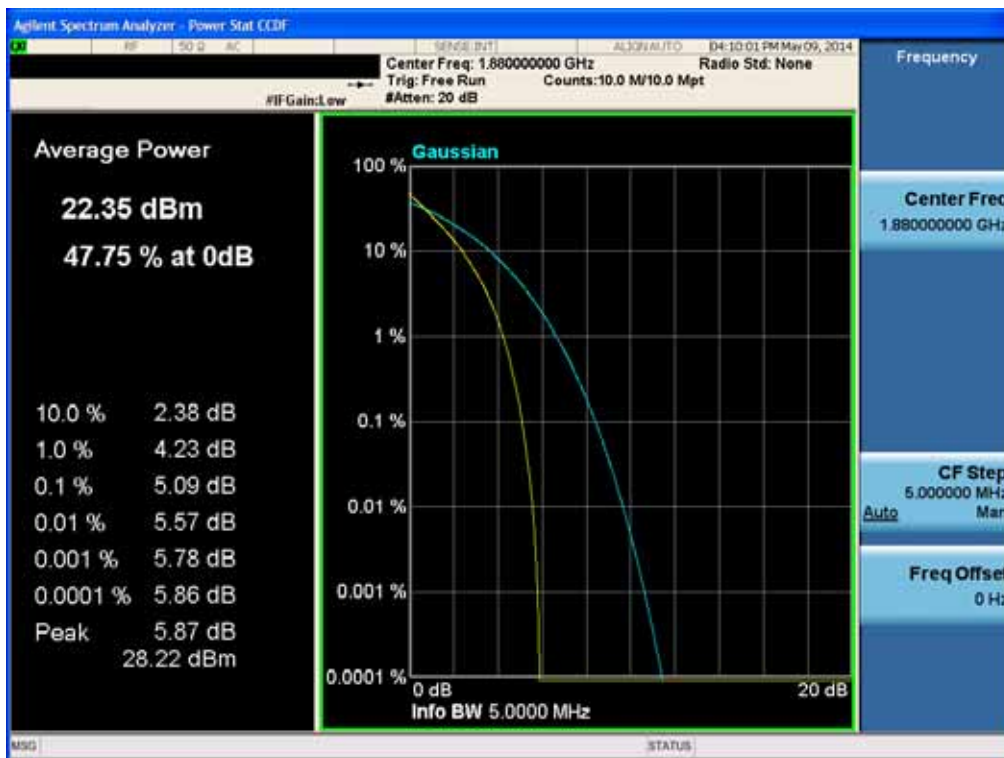
BAND 2. PAR Plot (5M BW Ch.18900 QPSK RB 25_0)
