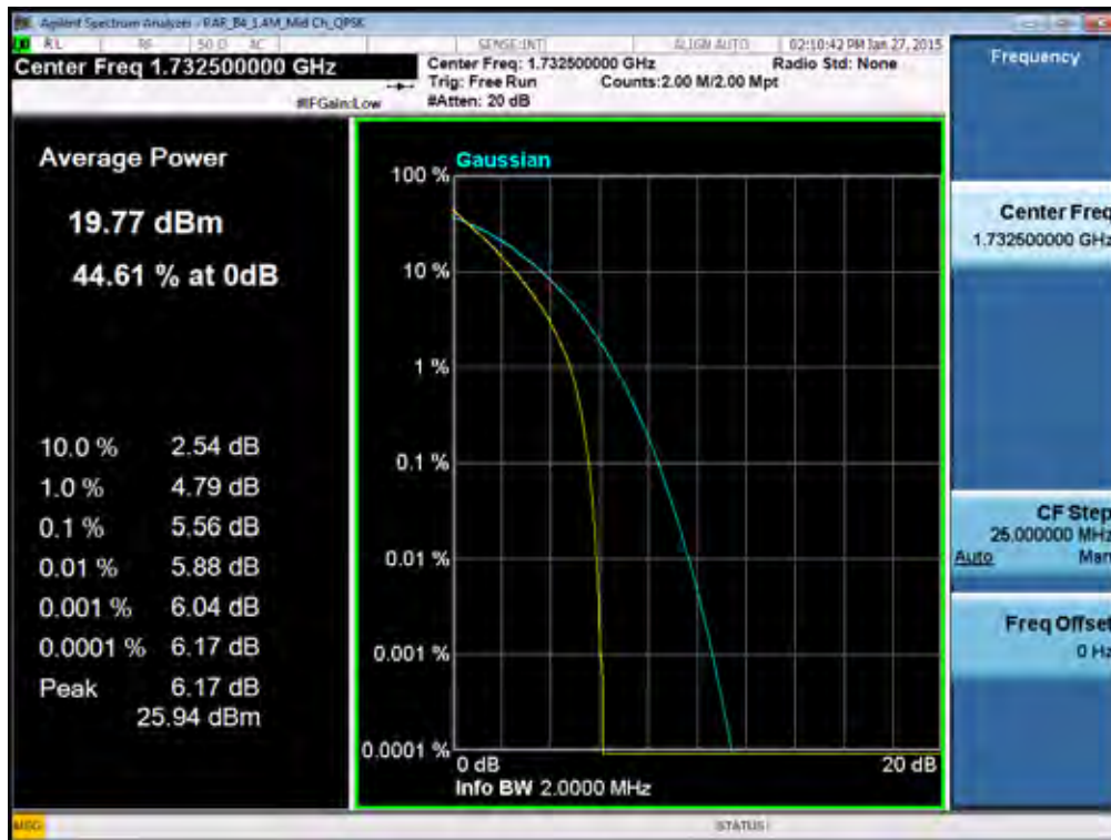
BAND 4. PAR Plot (1.4M BW_Ch.20175_QPSK_RB6_0)
