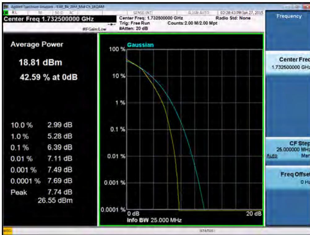
BAND 4. PAR Plot (20M BW_Ch.20175_16QAM_RB100_0)
