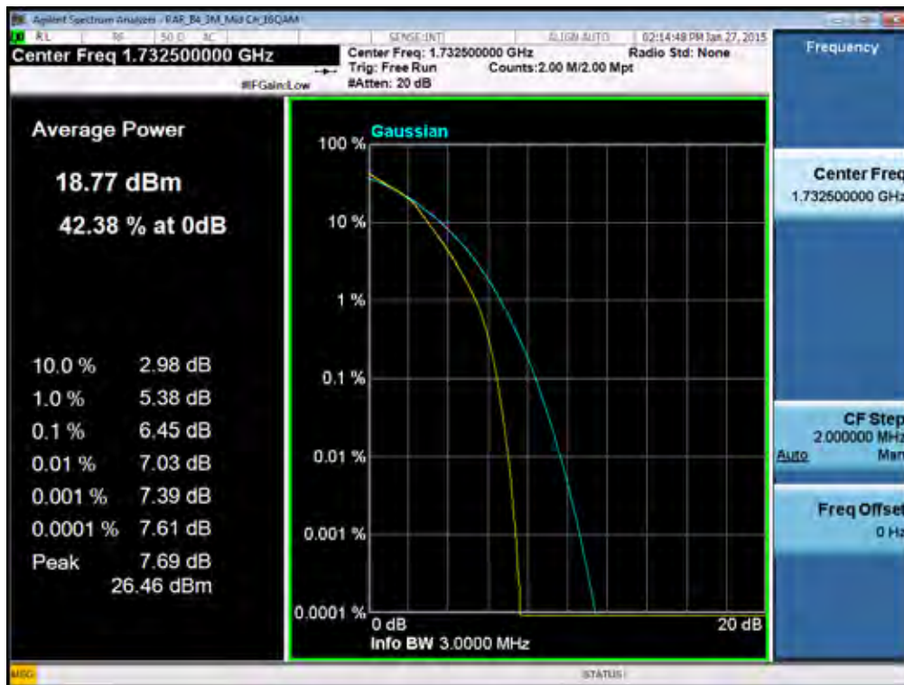
BAND 4. PAR Plot (3M BW_Ch.20175_16QAM_RB15_0)
