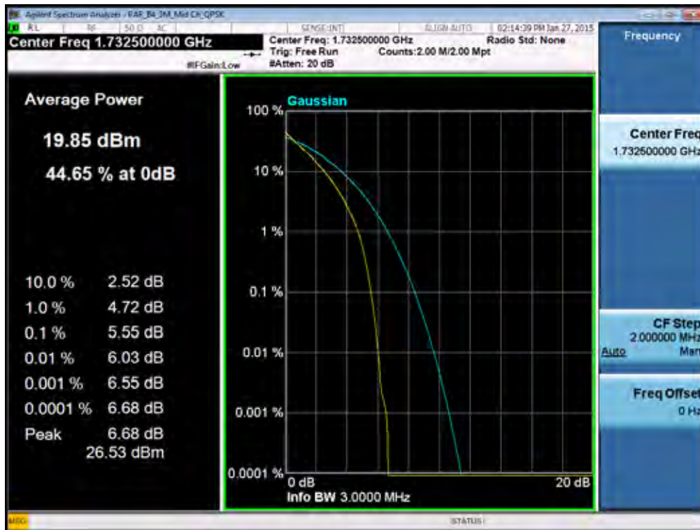
BAND 4. PAR Plot (3M BW_Ch.20175_QPSK_RB15_0)
