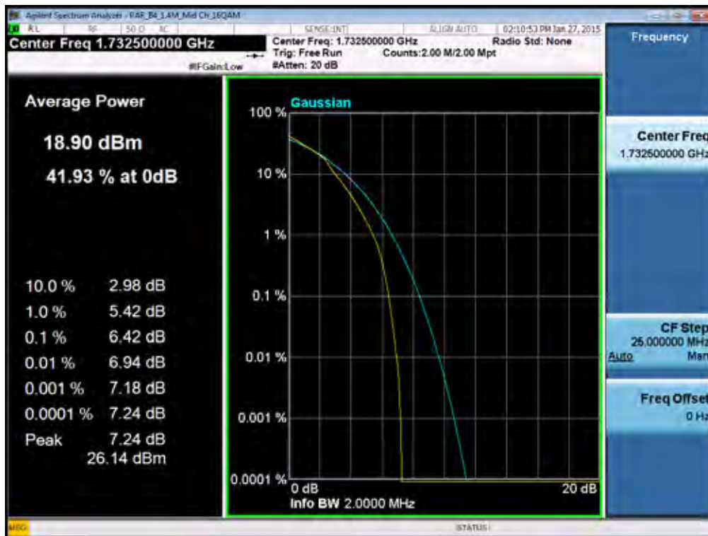
BAND 4. PAR Plot (1.4M BW_Ch.20175_16QAM_RB6_0)
