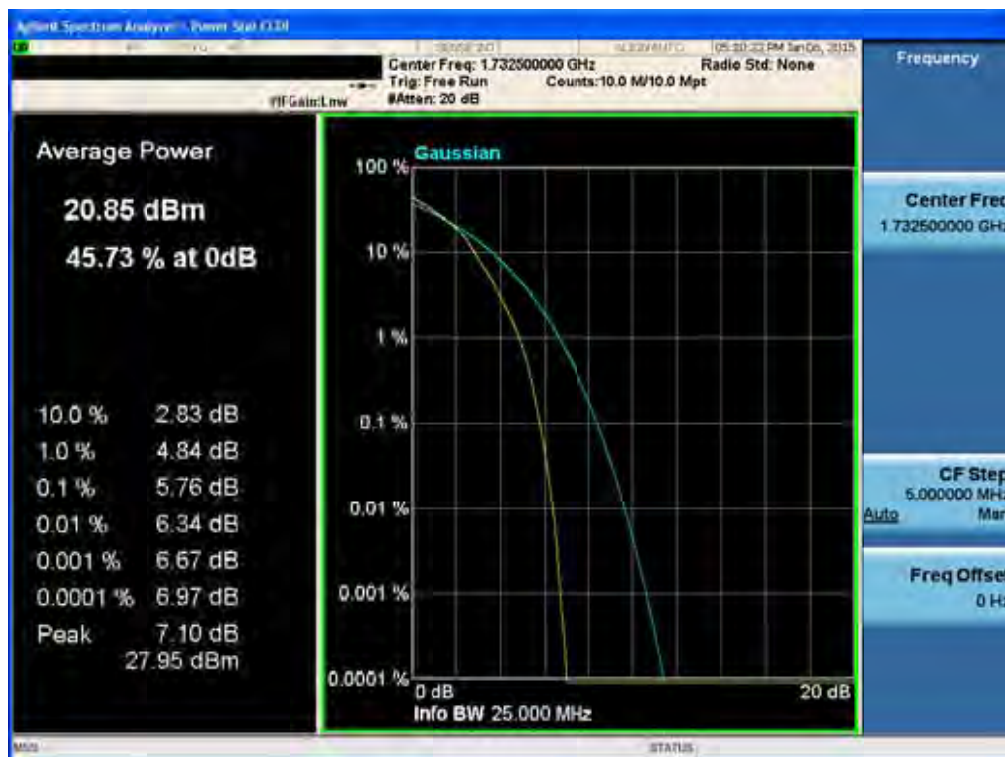
BAND 4. PAR Plot (15M BW_Ch.20175_16QAM_RB75_0)
