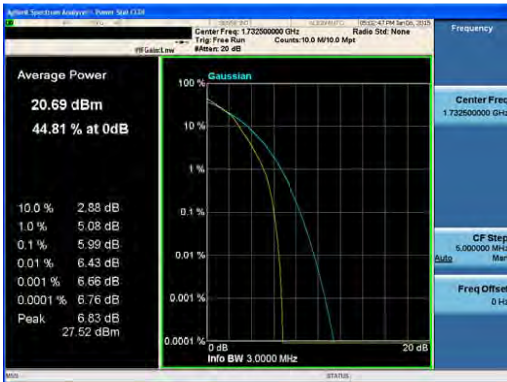
BAND 4. PAR Plot (3M BW_Ch.20175_16QAM_RB15_0)
