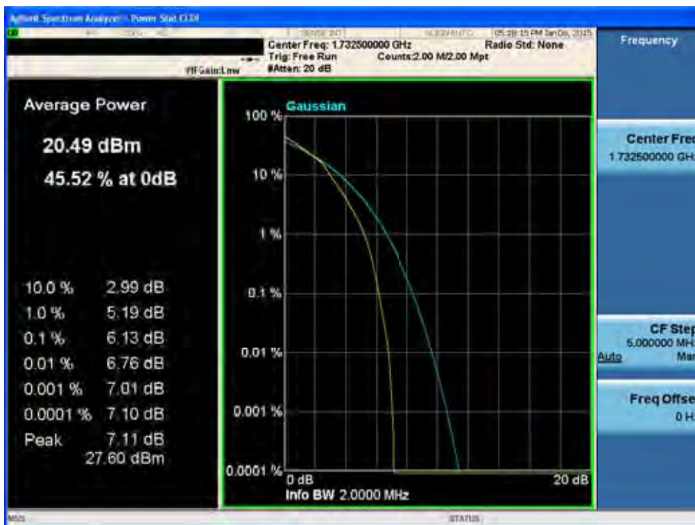
BAND 4. PAR Plot (1.4M BW_Ch.20175_16QAM_RB6_0)
