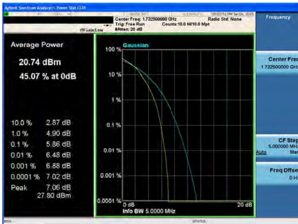
BAND 4. PAR Plot (5M BW_Ch.20175_16QAM_RB25_0)
