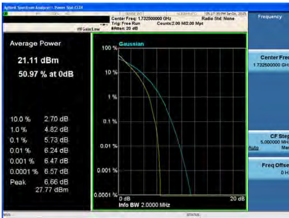
BAND 4. PAR Plot (1.4M BW_Ch.20175_QPSK_RB6_0)
