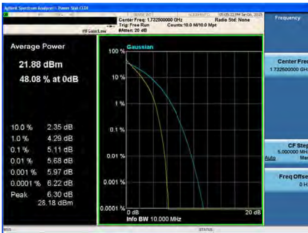
BAND 4. PAR Plot (10M BW_Ch.20175_QPSK_RB50_0)
