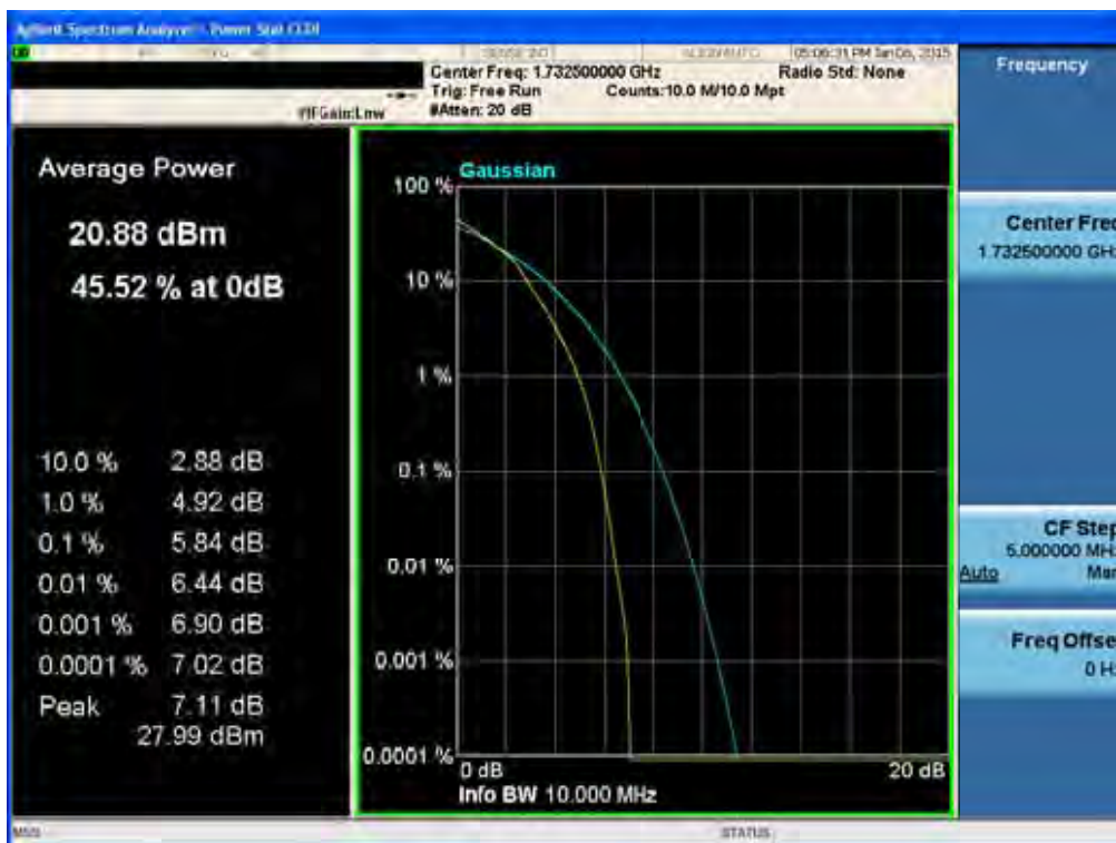
BAND 4. PAR Plot (10M BW_Ch.20175_16QAM_RB50_0)
