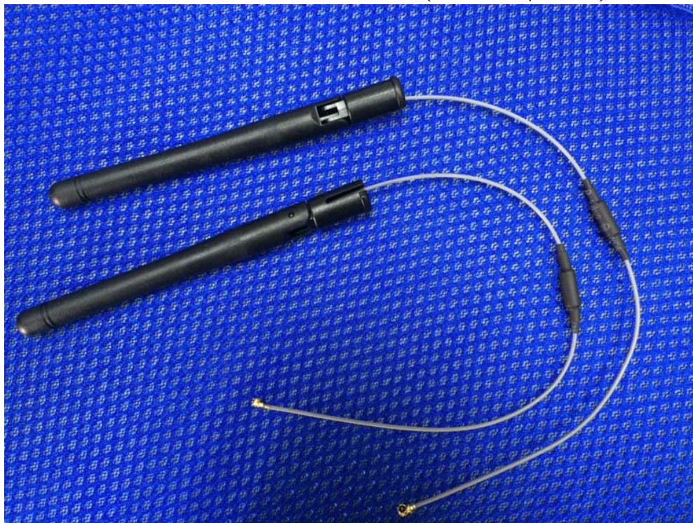
(35) EUT Photo - WALSIN / RFDPA870920IMLB305 (ferrite core \varnothing 4.0*10)
