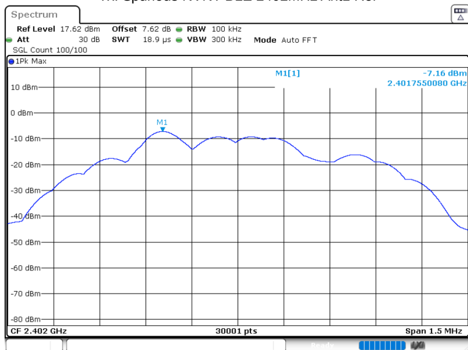
Tx. Spurious NVNT BLE 2402MHz Ant1 Ref
