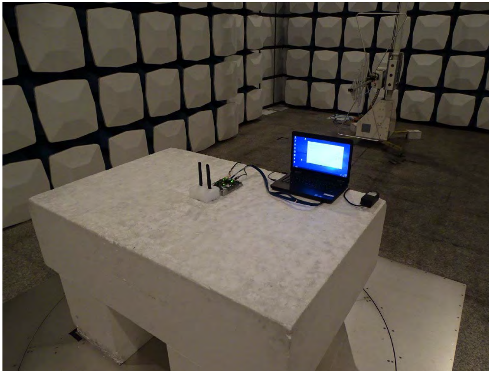
測試相片：輻射測試 正面相片
