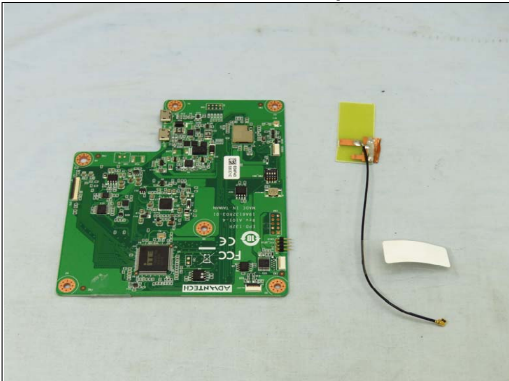
EUT with antenna P/N: AJMQ1J-B0009
