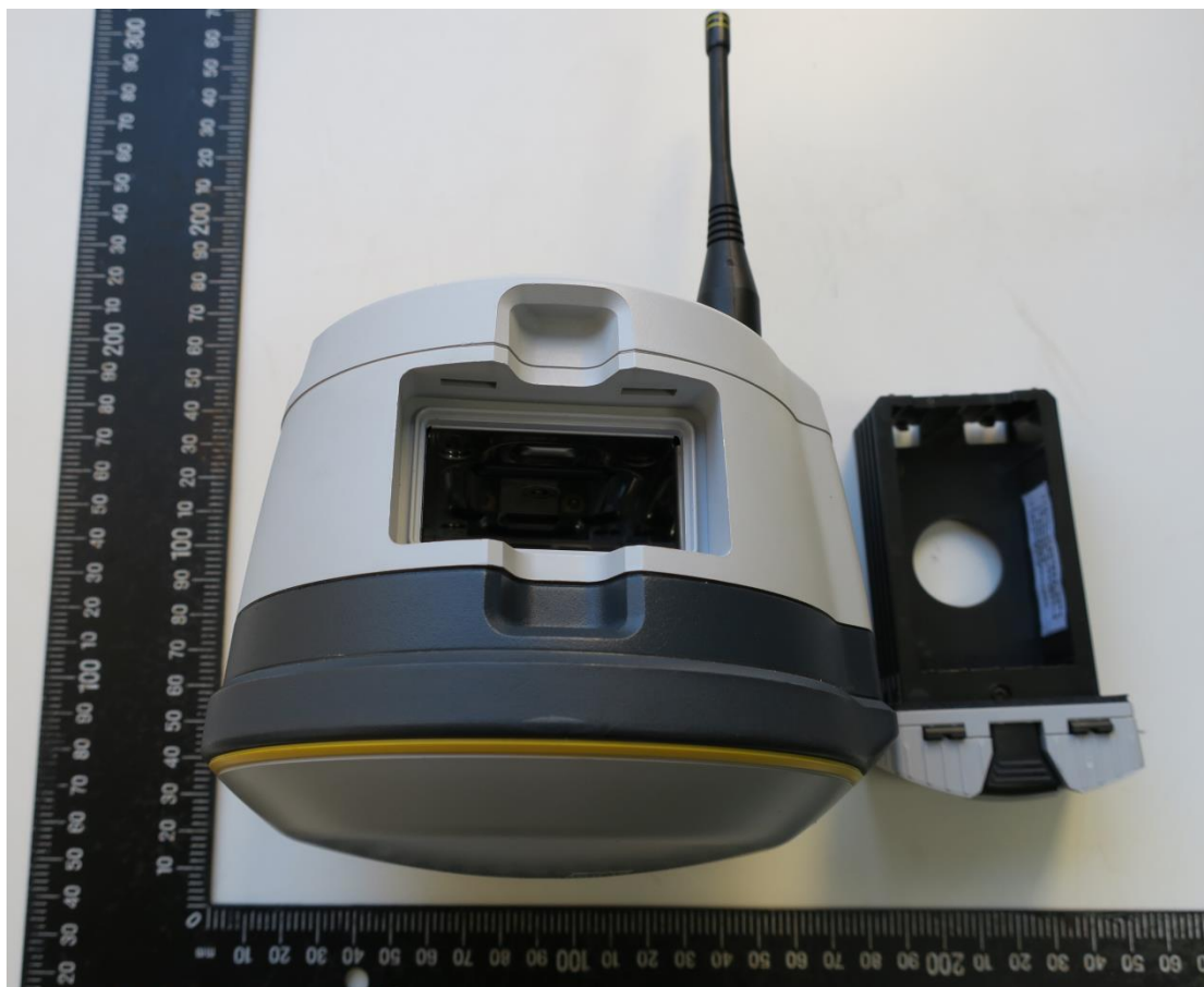
Trimble / R2 電池槽照
