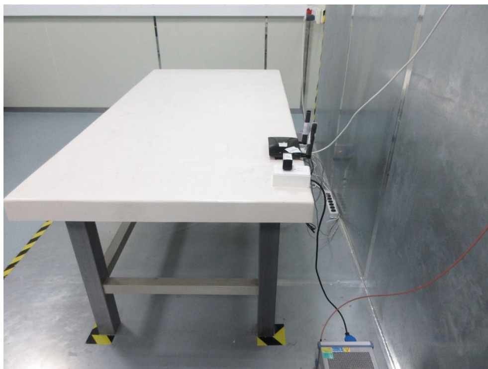
測試模式: Normal Mode 電源傳導測試 側面照 - 0.15MHz ~ 30MHz
