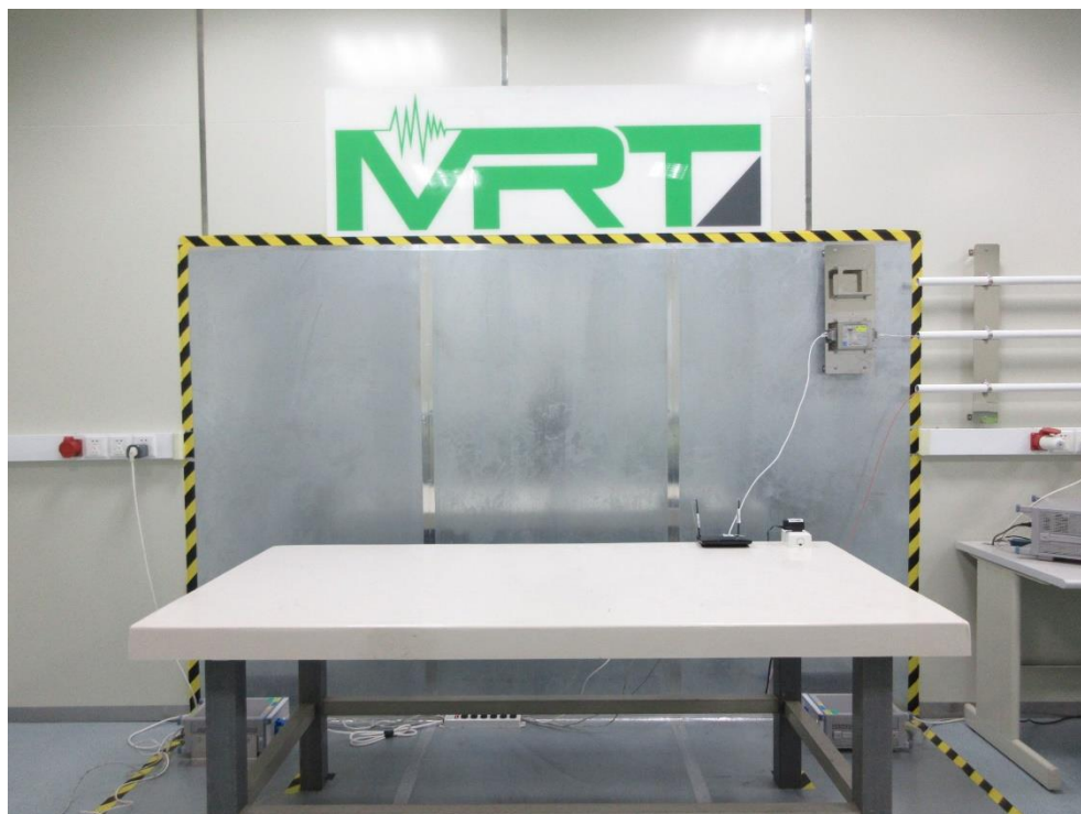
測試模式: Normal Mode 電源傳導測試 側面照 - 0.15MHz ~ 30MHz
