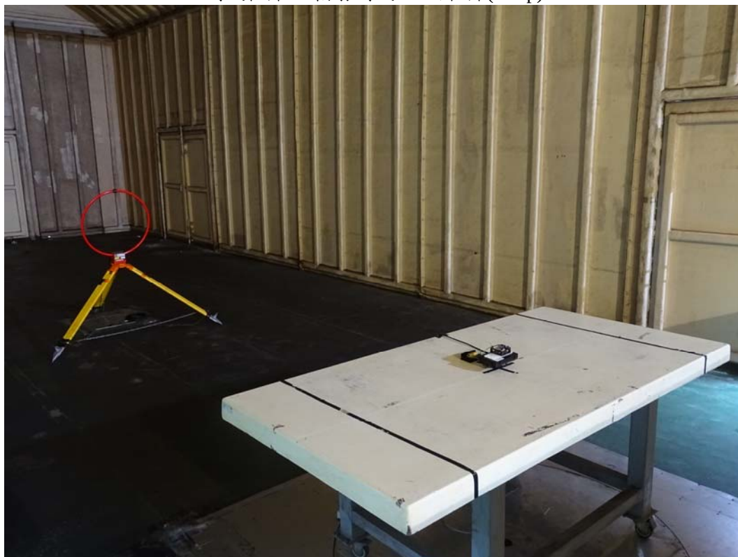
測試相片：輻射測試 正面相片(Loop)
